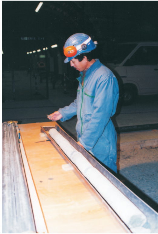
(b) Extraction et identification d'une carotte
