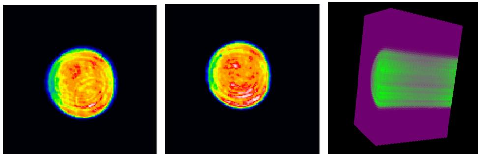
Figure 2.13 : (a) Profils de pompe utilisés pour le calcul de gain et (b) coupe du gain 3D obtenu
