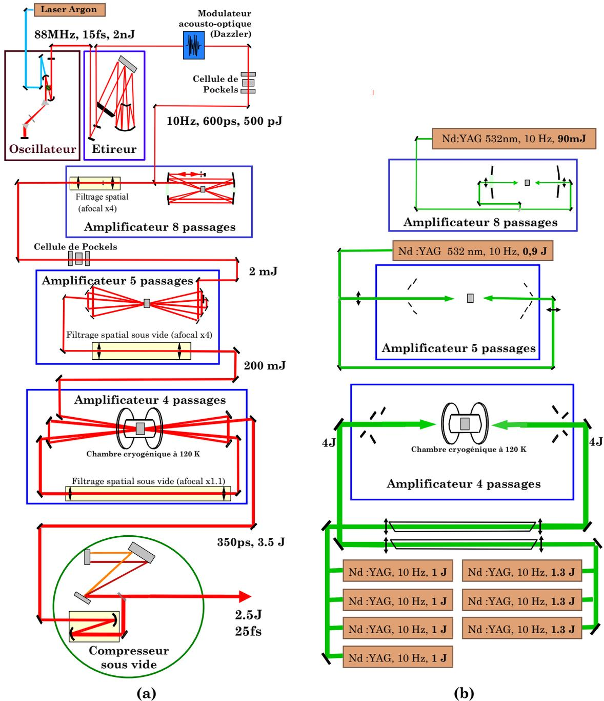
Figure 2.1 : Schéma de la chaîne laser 100 TW (a) Schéma du faisceau amplifié
