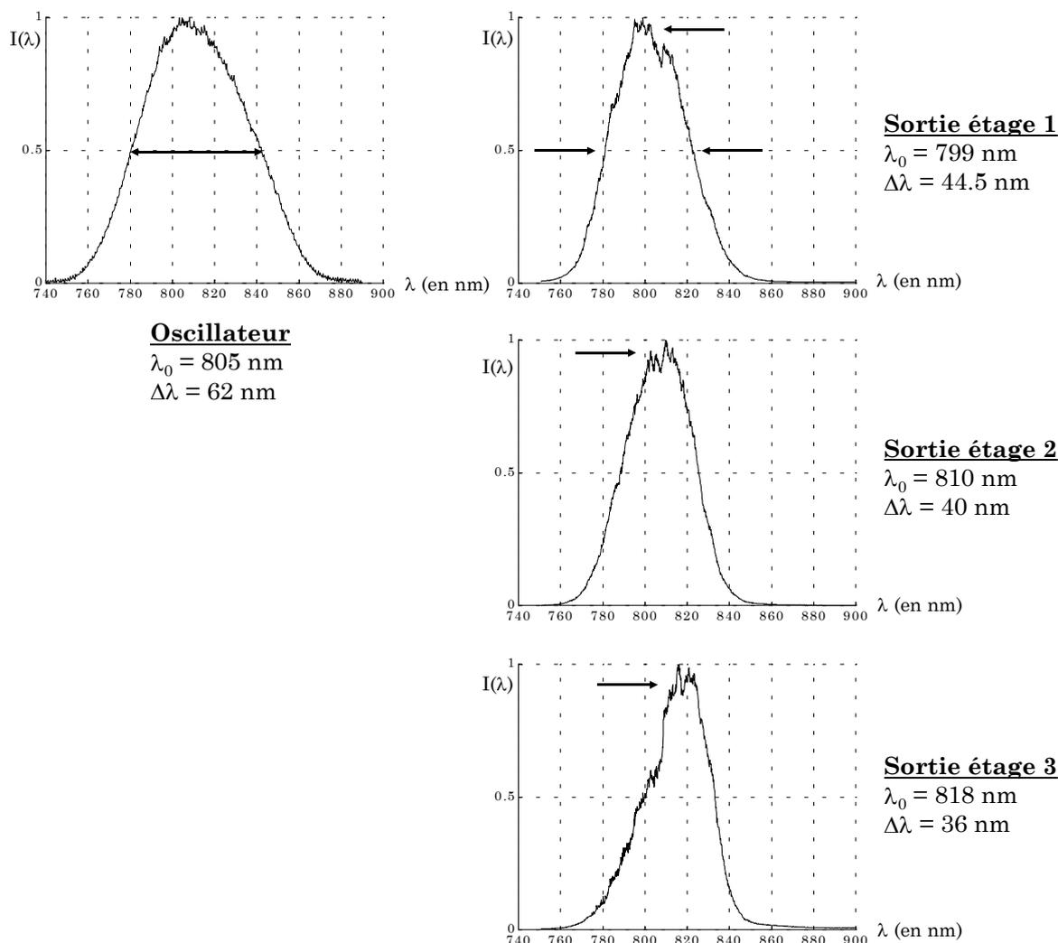
Figure 2.8 : Evolution du profil spectral du laser 100 TW
