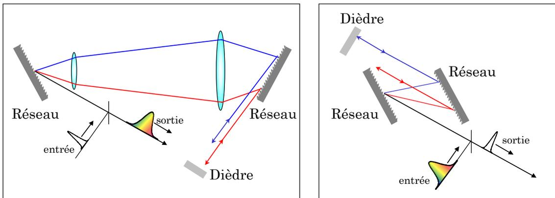
Figure 1.5 : Etireur à réseau (gauche) et compresseur à réseau (droite)
