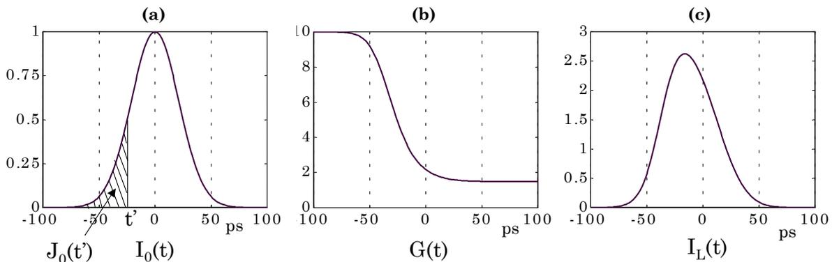
Figure 1.13 : Exemple d'évolution du profil temporel en présence de saturation
