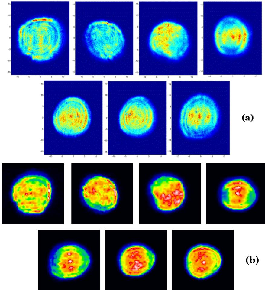
Figure 2.14 : Profils expérimentaux des 7 lasers de pompe du 3<sup>ème</sup> étage, (a) mesurés et (b) utilisés pour le calcul de gain. Les 4 lasers en haut sont envoyés sur une face et les trois autres sur la deuxième face du cristal
