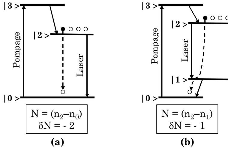
Figure 1.12 : Comparaison entre une transition à trois niveaux (a) et quatre niveaux (b).
