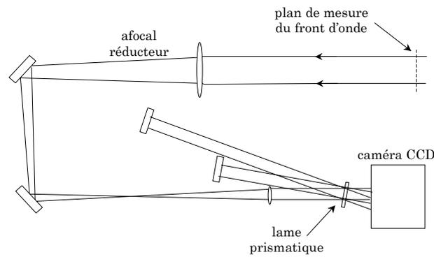
Figure 4.10 : Principe du montage MIROMA ([13])
