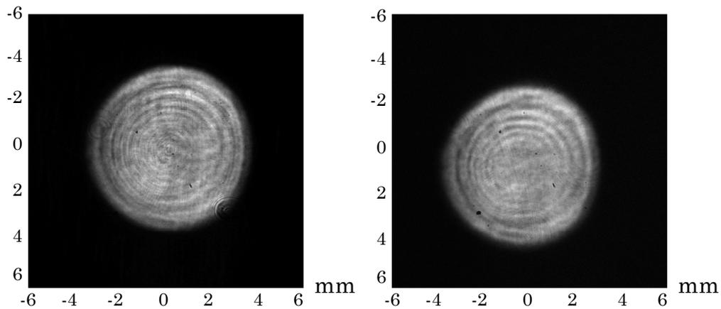
Figure 2.12 : Profils mesurés du laser de pompe du 2<sup>ème</sup> étage sur chaque face du cristal
