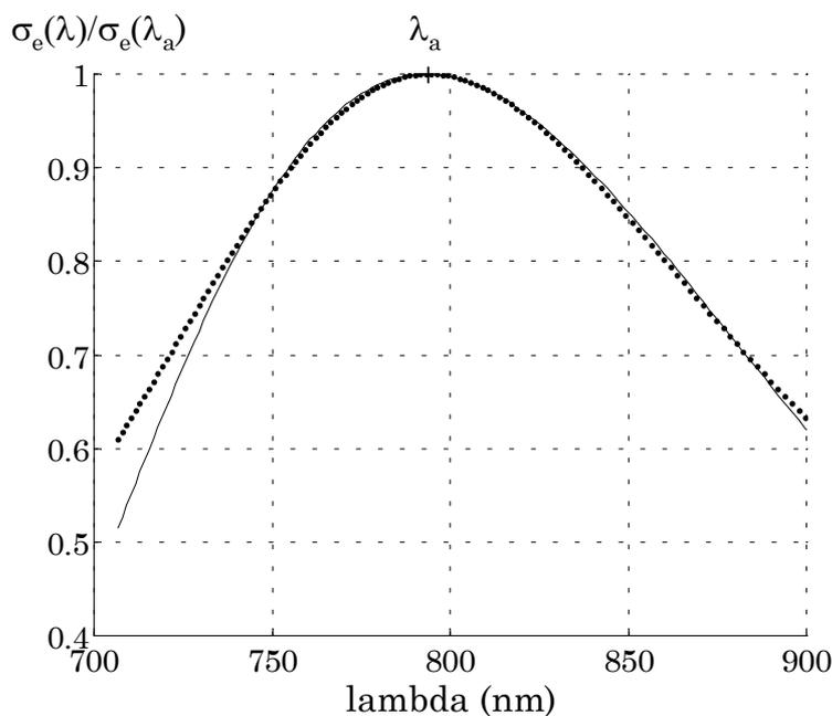
Figure 2.6 : Spectre d'émission stimulée (spectre de gain) du Titane saphir :
