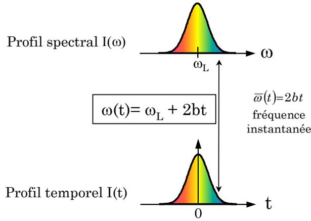
Figure 1.15 : Correspondance temps-fréquence pour une impulsion étirée
