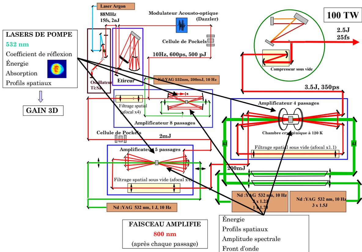
Figure 2.4 : Mesures expérimentales de caractérisation du laser 100 TW
