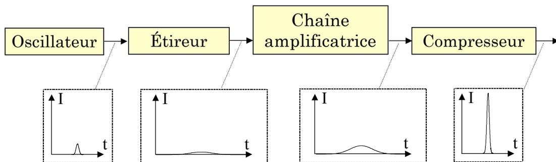
Figure 1.3 : Principe de l'amplification à dérive de fréquence
