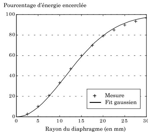
Figure 5.6 : Energie encerclée mesurée derrière la lentille  $f_2$
