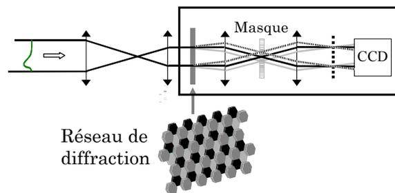
Figure 4.8 : Dispositif interférométrique à décalage tri-latéral
