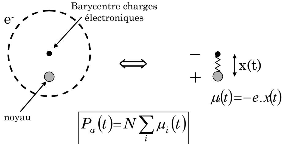
Figure 1.7 : Modèle de l'oscillateur électronique classique. Le nuage électronique est assimilé à son barycentre dont la position est donnée par  $x(t)$ . L'oscillation crée une polarisation microscopique  $\mu_i(t)$
