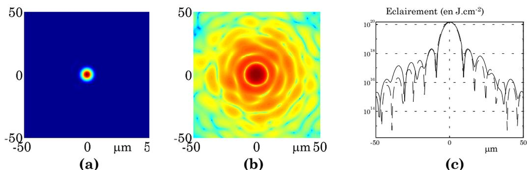
Figure 4.29 : Taches focales calculée à partir du front d'onde résiduel. (a) échelle linéaire. (b) échelle logarithmique. (c) Coupe du profil en trait plein comparé avec le profil obtenu pour une phase spatiale nulle (trait pointillé)
