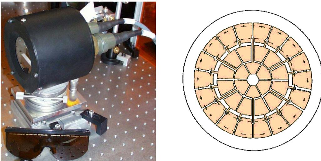
Figure 4.14 : Miroir déformable BIM36 utilisé et ses 36 actionneurs
