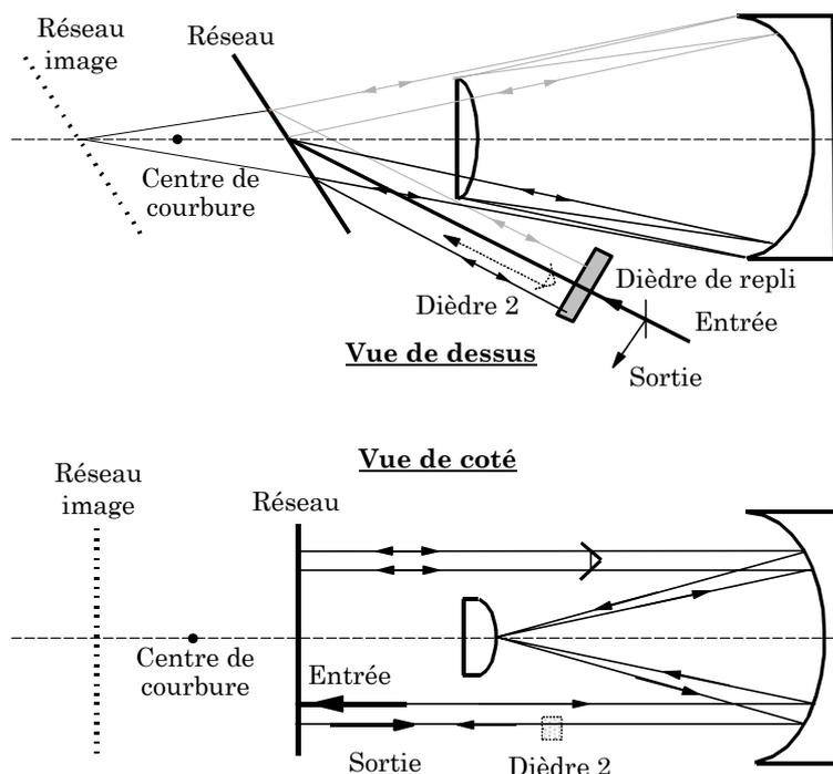
Figure 2.3 : Schéma d'un étireur de type Offner
