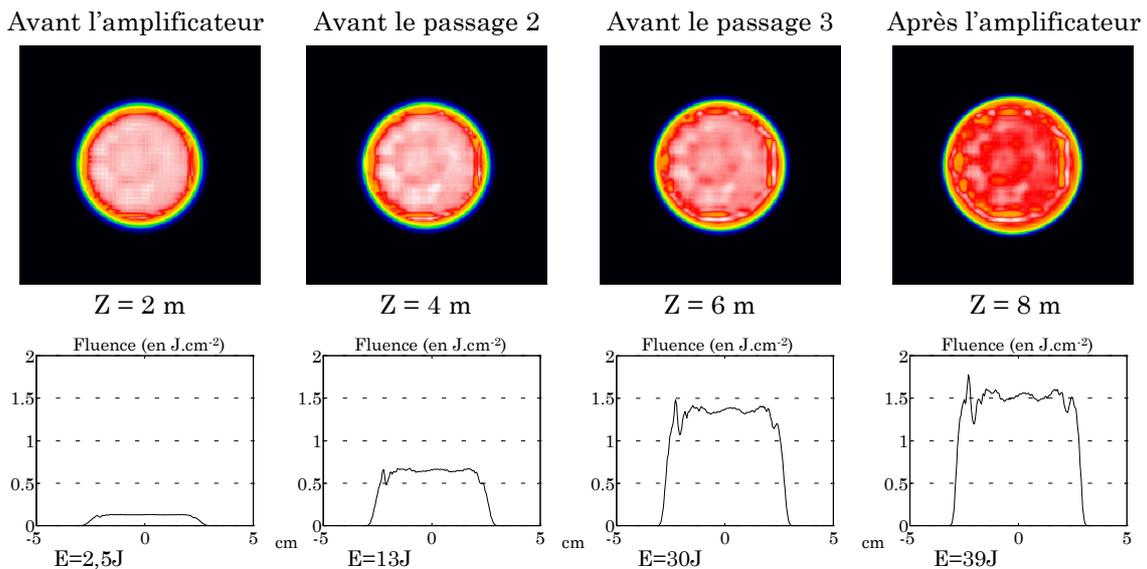
Figure 4.24 : Profil du faisceau dans un amplificateur
