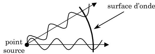
Figure 4.3 : Exemple de surface d'onde sphérique
