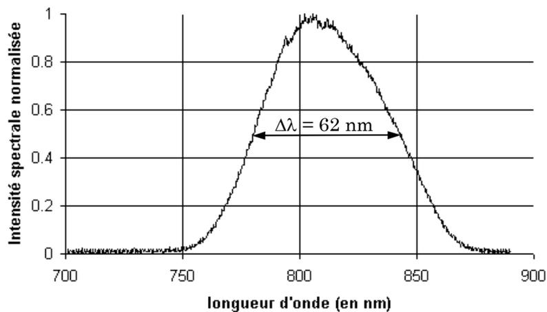
Figure 2.2 : Spectre de l'oscillateur à blocage de modes
