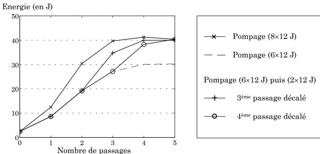
Figure 3.12 : Evolution de l'énergie de l'amplificateur PW selon la synchronisation utilisée
