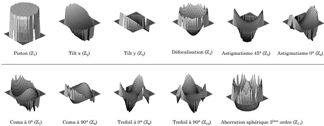
Figure 4.6 : Allure des polynômes de Zernike du 3<sup>ème</sup> ordre
