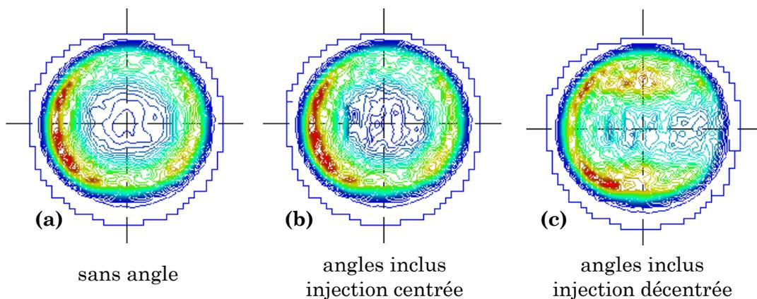
Figure 2.21 : Gain résiduel après amplification dans le deuxième amplificateur
