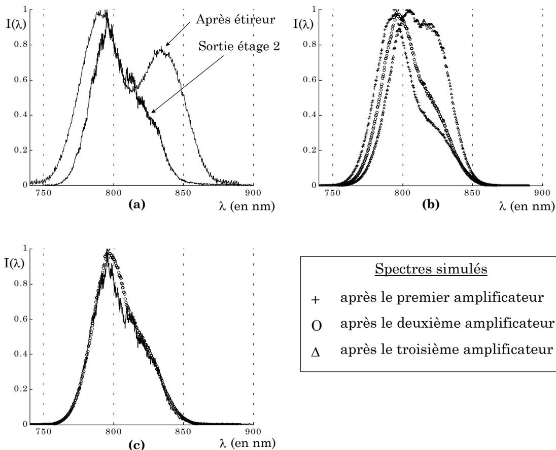
Figure 2.10 : Spectres obtenus avec une modulation par Dazzler. (a) Spectres mesurés, après l'étireur et après le deuxième étage. (b) Spectres simulés après le 1<sup>er</sup>, 2<sup>ème</sup> et le 3<sup>ème</sup> étage. (c) superposition des spectres mesurés et simulés pour le 2<sup>ème</sup> étage
