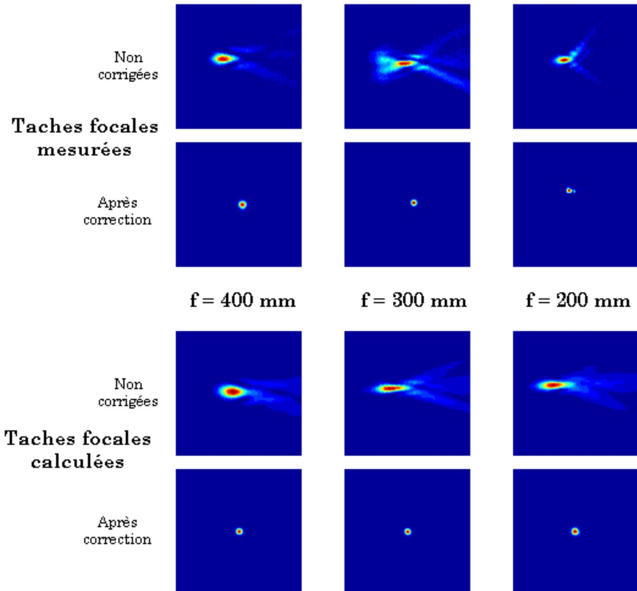
Figure 4.19 : Taches focales - avant et après correction - mesurées par la caméra CCD (haut) et calculées à partir des mesures du SHWS (bas)
