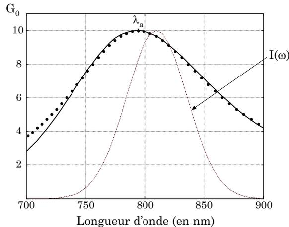
Figure 1.16 : Courbe de gain petit signal ( $G_0(\lambda_a)=10$ ) obtenue en utilisant une loi de Poisson pour la section efficace (points). Le trait plein correspond à un ajustement par une Lorentzienne. Un exemple de profil spectral d'une impulsion gaussienne est figuré en pointillés ( $\Delta\lambda=60$  nm à  $\lambda_L=810$  nm)
