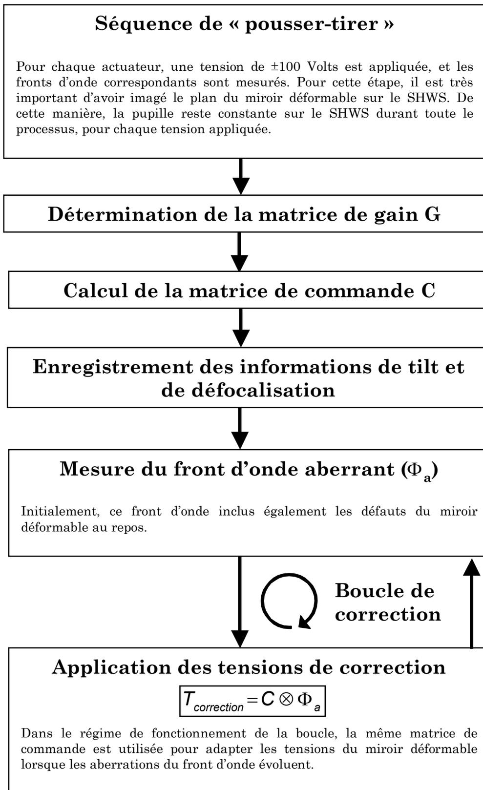
Figure 4.16 : Séquences utilisées pour la boucle de correction
