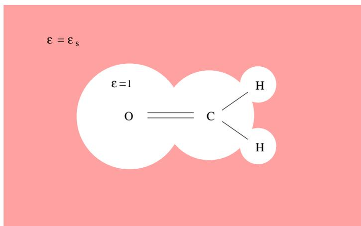
FIG. 11:  $\text{H}_2\text{CO}$  en solution aqueuse : modèle du continuum.
