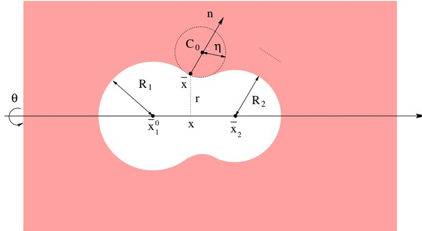
FIG. 7: Cavité moléculaire  $\Omega^{se}$  pour une molécule diatomique.
