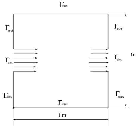
FIG. 7.9: Cavit e m etallique/absorbante
