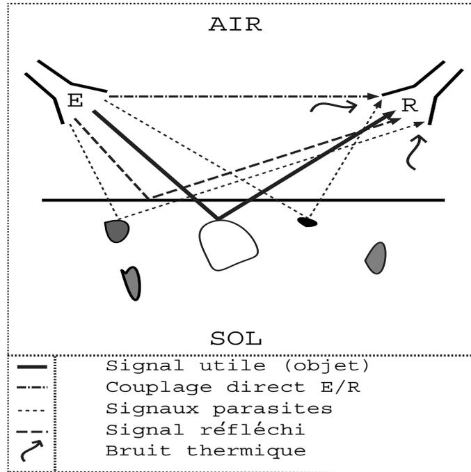
FIG. 4.13 – *Signal mesuré*
