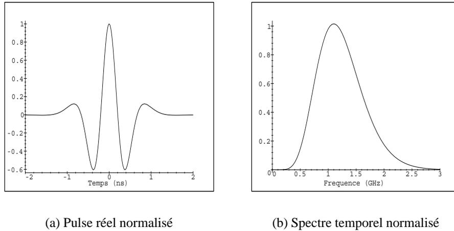
FIG. 3.6 – *Pulse utilisé pour les simulations*
