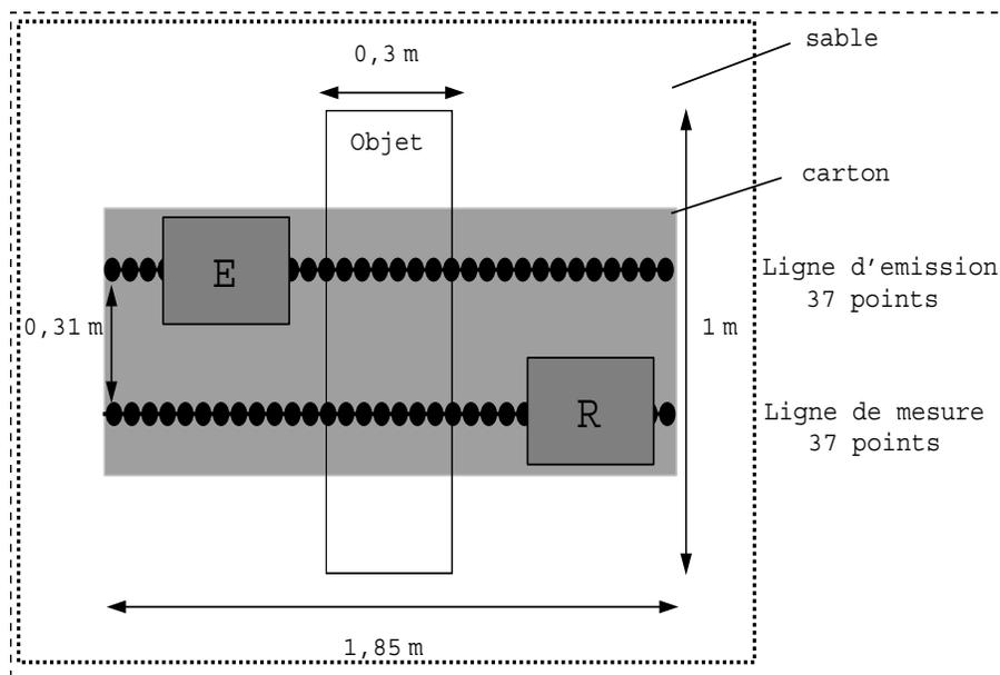
FIG. 4.6 – Configuration de la mesure (vue de dessus)
