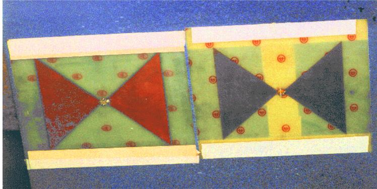
FIG. 4.4 – Image des deux antennes papillon
