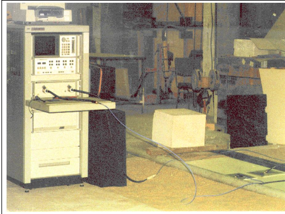
FIG. 4.2 – Système de mesure (Analyseur + Antennes)
