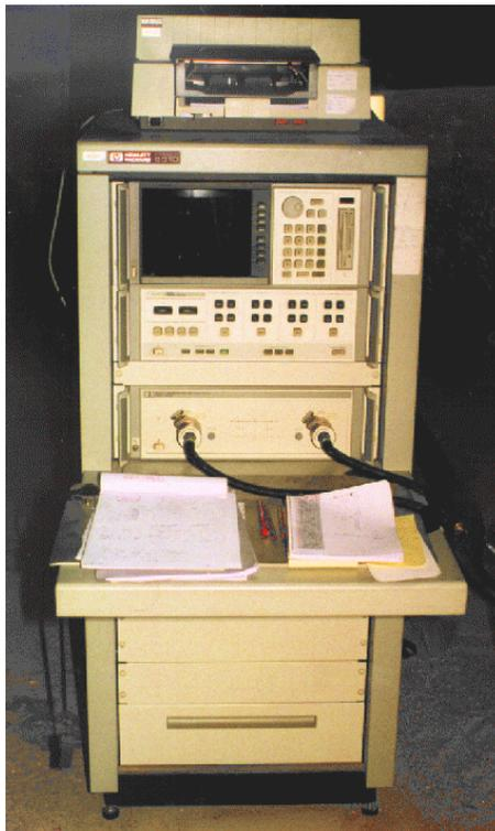
FIG. 4.3 – Analyseur de réseau HP8510
