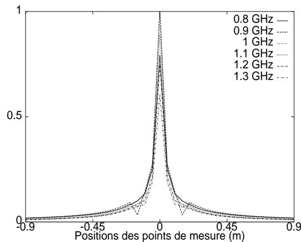
FIG. 3.18 – Champ d'antenne normalisé dans la bande  $[0,8;1,3]$  GHz
