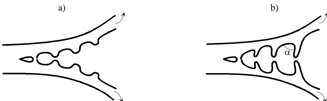
Figure III.23 Séparation des bandes de pelage : rupture plutôt a) fragile b) ductile
