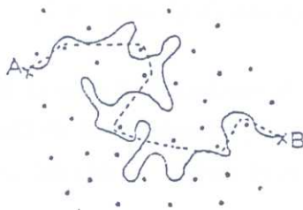
Figure I.15 Chaîne réelle (—) primitive path (---) (Doi et Edwards, 1978)
