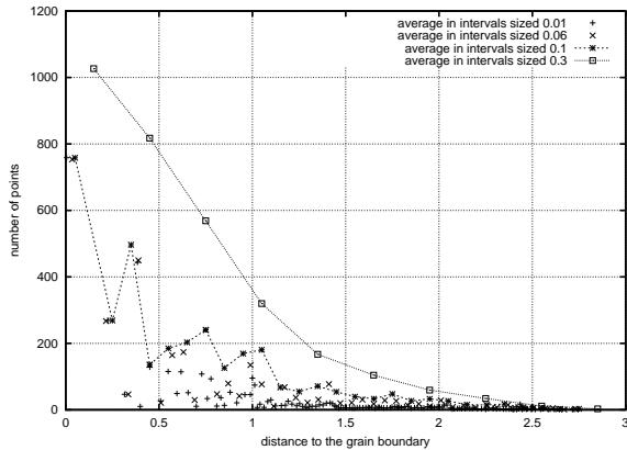
**Figure III.22 :** Nombre *moyen* de points dans chaque intervalle de distance au joint de grain, pour des intervalles de taille 0.01, 0.06, 0.1, 0.3, en fonction de la distance au joint de grain
