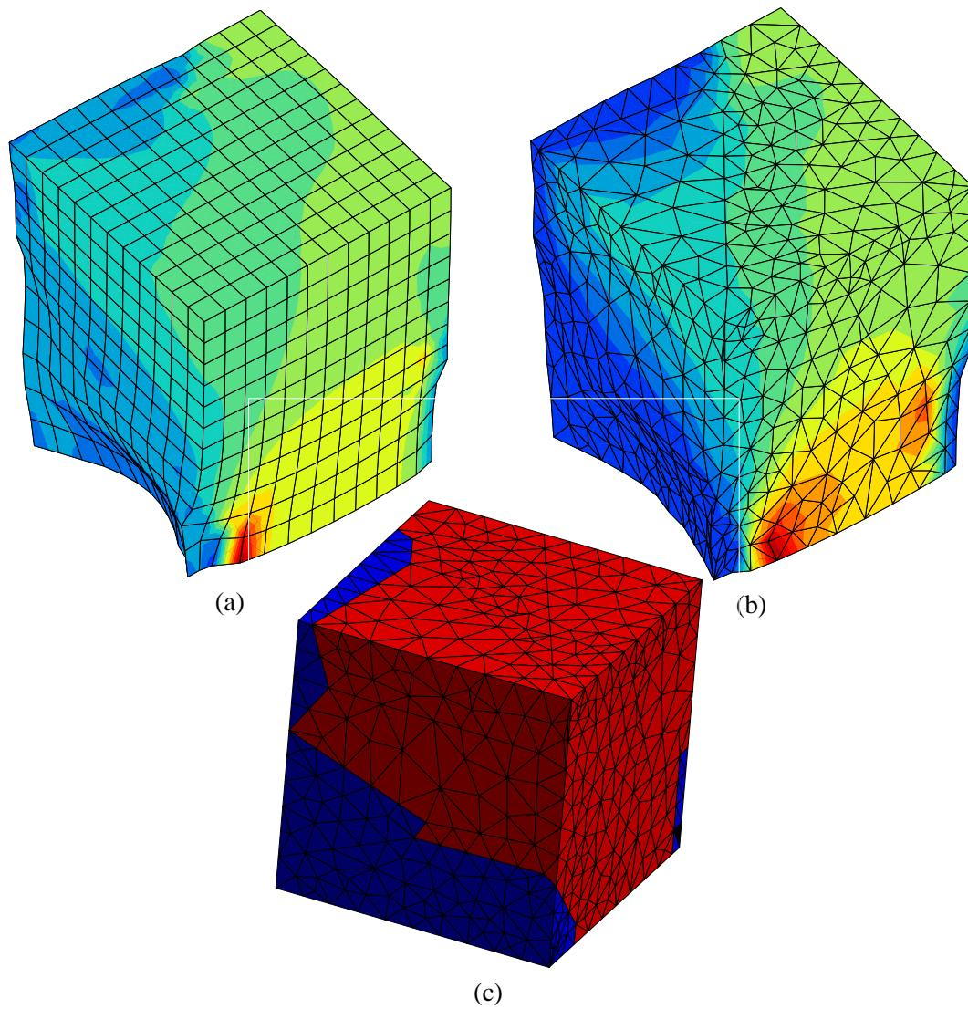
**Figure II.11 :** Effet du choix des éléments sur la contrainte axiale locale d'un biphasé élastique ; le contraste des modules vaut 100, le milieu est constitué de 20 grains sous forme de polyèdres de Voronoï répartis en 2 phases, 70% de dur, 30% de mou ; (a) cubes à 8 nœuds, (b) tétraèdres, (c) microstructure ( [Kanit, 2000])
