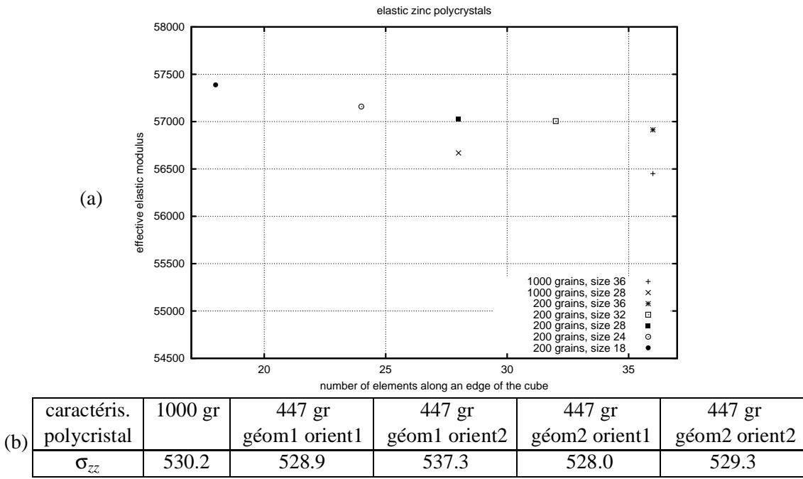
**Figure II.18 :** Réponses effectives d'agrégats de zinc en élasticité : (a) modules élastiques pour 200 et 1000 grains, pour un nombre variable d'éléments ; (b) contrainte axiale pour deux réalisations d'agrégats à 447 grains et deux jeux d'orientations aléatoires
