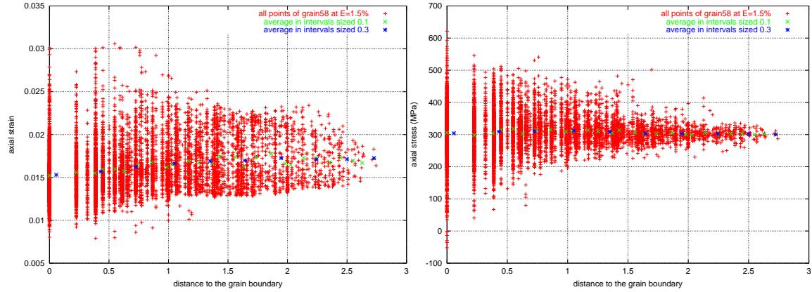
**Figure III.18 :** Réponse locale en chacun des points de *grain58* (le plus gros de la microstructure à 200 grains *m4*) en fonction de la distance au joint de grain ; (gauche) déformation axiale, (droite) contrainte axiale
