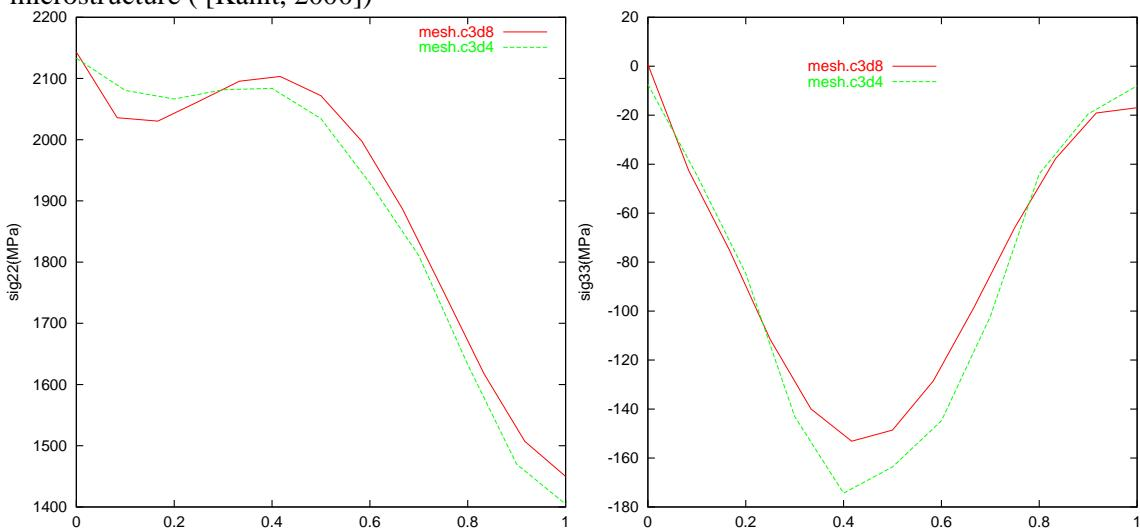
**Figure II.12 :** Evolution  $\frac{z}{z}$  de la contrainte axiale (gauche) et latérale (droite) le long des nœuds d'une arête perpendiculaire à l'axe de traction sur les cubes des figures II.11a,b ( [Kanit, 2000])
