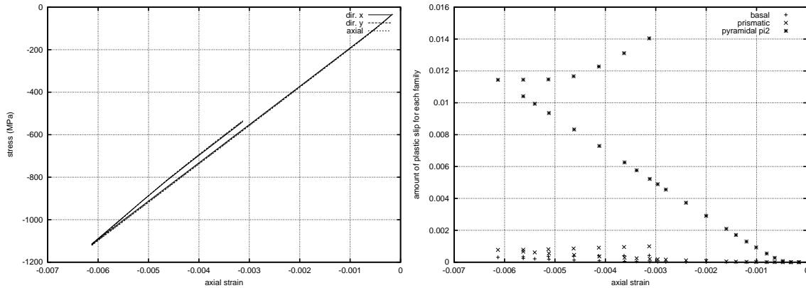
**Figure III.16 :** Courbes effectives d'un polycristal de zinc élastoplastique en chargement hydrostatique alterné (charge, décharge) : (gauche) contraintes, (droite) somme sur les systèmes des glissements cumulés, pour les trois familles
