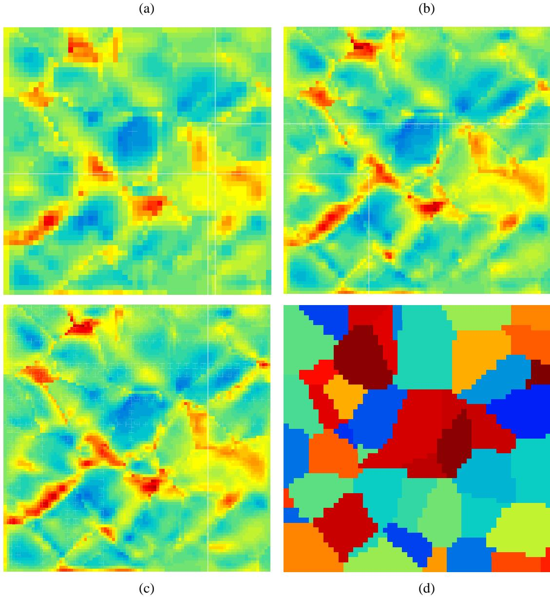
**Figure II.20 :** Comparaison de la distribution de la somme des glissements ( $\sum_s |\gamma^s|$ ) sur une tranche de l'agrégat *m4* décrit avec (a)  $18 \times 18 \times 18$  éléments, (b)  $28 \times 28 \times 28$  éléments, (c)  $32 \times 32 \times 32$  éléments, (d) Carte des grains sur la structure à  $18 \times 18 \times 18$  éléments
