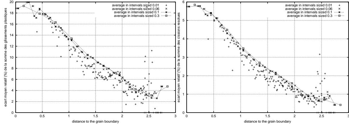
**Figure III.21 :** Ecart Moyen Relatif en moyenne dans des intervalles de distances au joint de grain (de taille 0.01, 0.06, 0.1, 0.3) en fonction de la distance au joint de grain ; ces variables sont aussi moyennées sur l'ensemble des grains ; (gauche) écart moyen pour la somme des glissements, (droite) écart moyen pour la somme des cissions résolues
