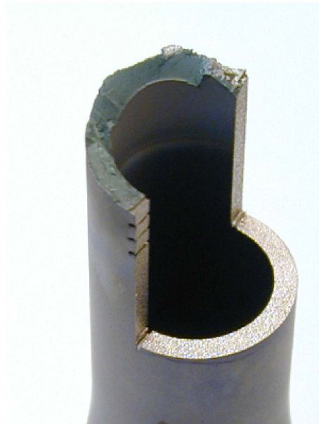
Figure VI.12 : Découpe de l'éprouvette par électro-érosion
