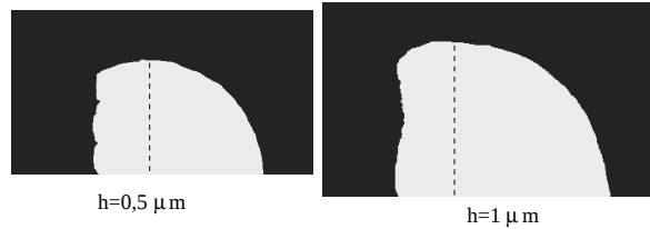
FIG. 4.51 – Aire de contact matériau indenteur pour la rayure avec le cône \theta=30^\circ , \rho=600 nm sur le polycarbonate.
