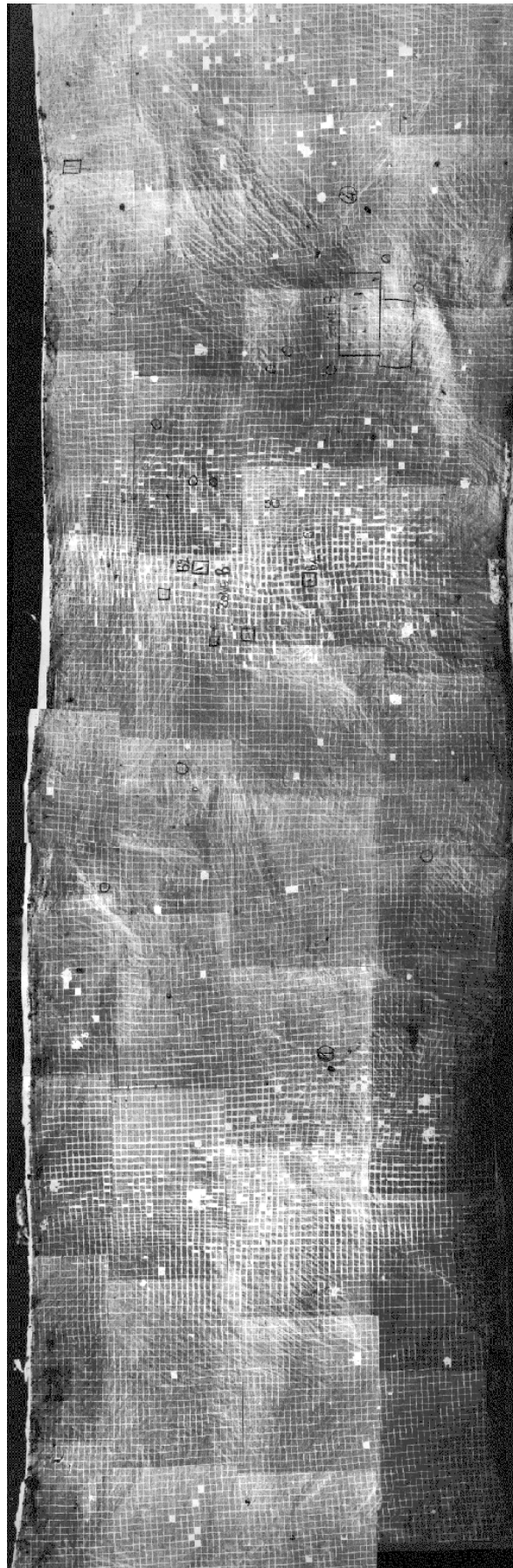
FIG. IV.15 – Aspect général de la surface de l'éprouvette T3 après 12% de déformation macroscopique.
