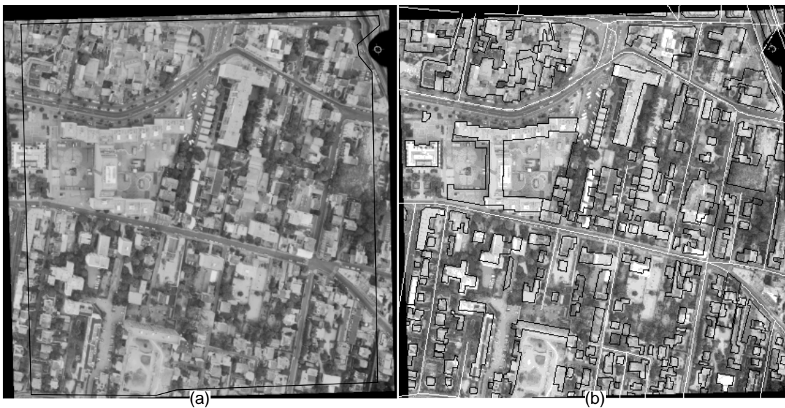
(a) : En noir, l'emprise de la zone traitée ; (b) : En noir, bâti de la BDTopo ; en blanc, réseau routier de la BDTopo.
