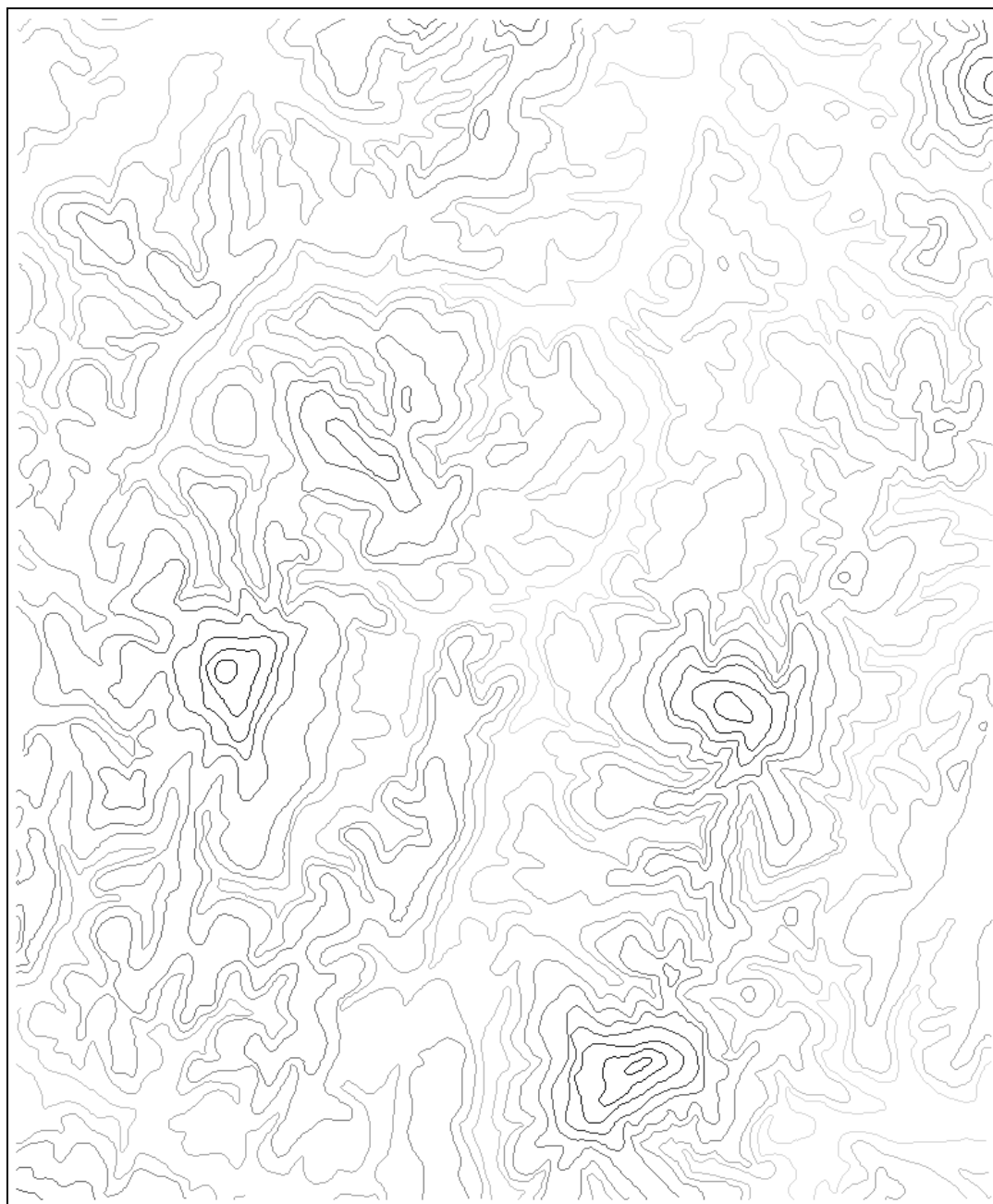
FIG. 6.14 – Courbes de niveau extraites de la carte IGN (Fig 6.13) par digitalisation (échelle d'altitude représentée en niveau de gris).
