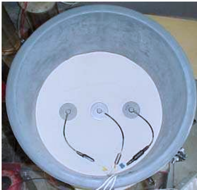
Fig. 3-22 : Capteurs du CECP d'Angers posés sur le sable dans le moule (expérimentation L_2 )
