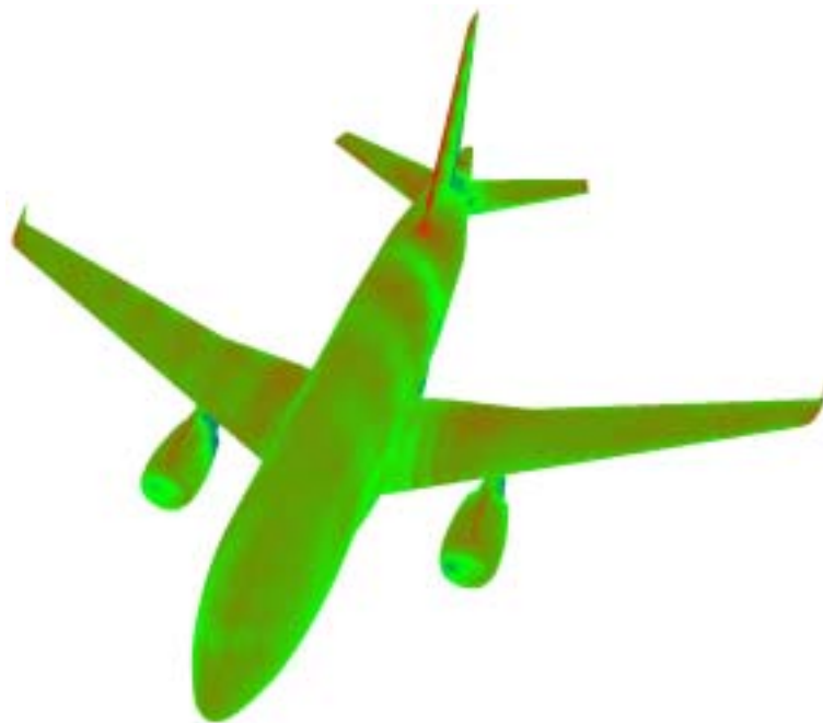
FIG. 3.28 – Courant surfacique sur un Airbus
