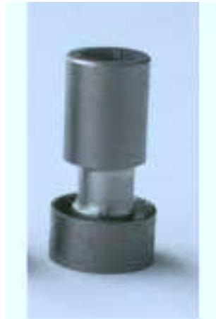
micrographie VIII.7 : Assemblage d'un préfritté 50/50 dense de hauteur 5mm entre deux pièces massives en TiAl après traitement thermique à 1150°C pendant 8h sous vide secondaire avec un "getter" en Zircaloy.
