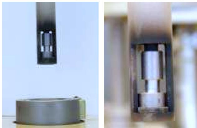
micrographie VIII.4 : Montage de dilatométrie pour le brasage-diffusion de préfrittés TiAl/TiCuNi entre deux pièces massives en TiAl.
