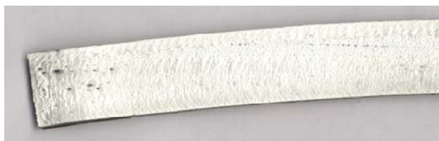
Figure IV.4 :Rupture cohésive dans l'EBA, tube 10 (côté bande)
