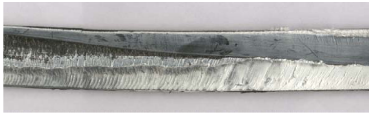
Figure IV.7 : Anomalies observées sur le faciès de rupture du tube 10 (côté bande)
