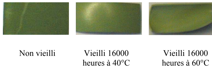
Figure III.13 : Observation visuelle des dégradations de l'époxy vieilli environ 16000 heures dans l'eau distillée à 40 et 60°C (grossissement x 0.7)
