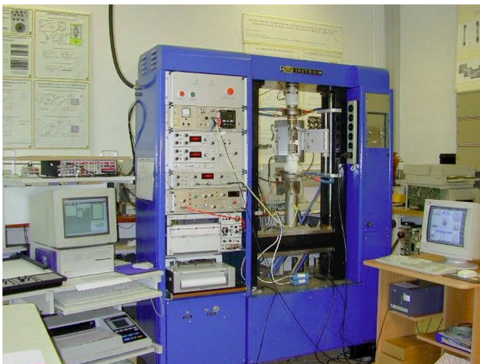
Figure G-1 □ Montage de fatigue mécano-thermique équipé de la chaîne d'émission acoustique
