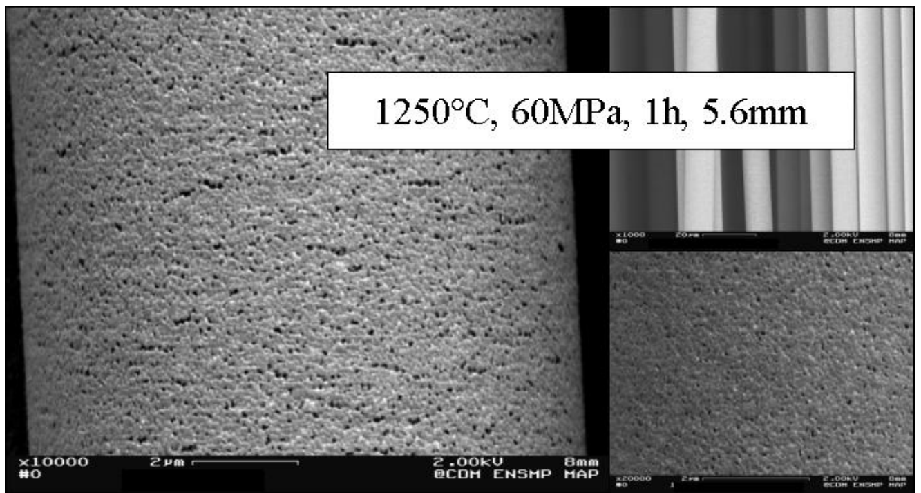
Figure C-21 Photographies de la surface des fibres d'une mèche après fluage à 1250°C (20 et 60MPa par fibre).
