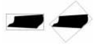
FIG. 5.2 – Exemple de balayage « vu de dessus ». Suivant l'orientation du maillage, le volume reconstruit sera plus ou moins important.
