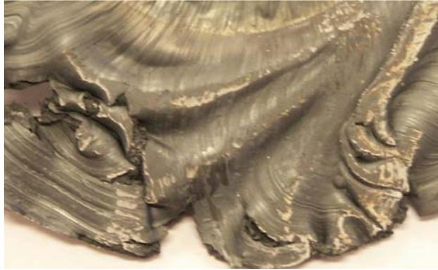
*Figure 39 : Zoom sur les replis de matière observés sur les pièces filées sur une pièce d'épaisseur filée de 4mm*
