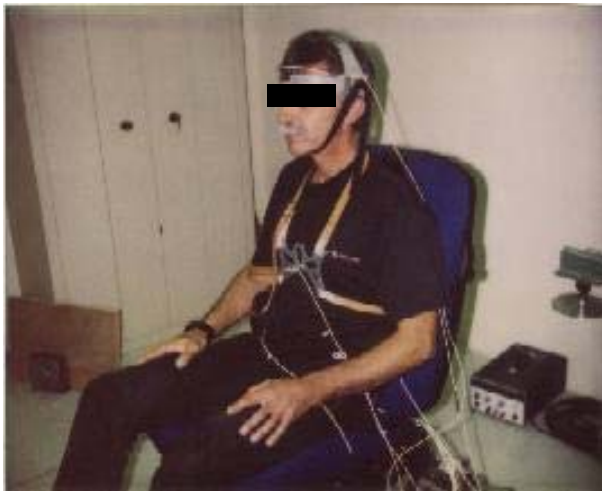
Figure 125 : Instrumentation du sujet lors des mesures de transmissibilité sur siège réel.
