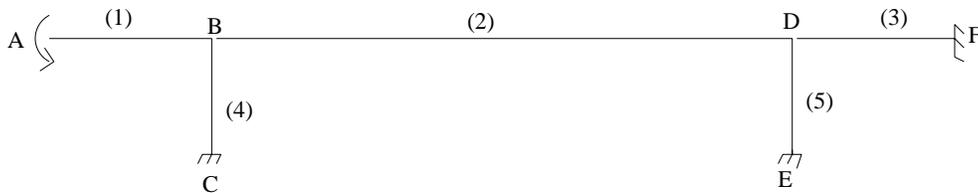
FIG. 6.37 - Treillis de poutres reliées rigidement, encastré en C, E, F et contrôlé en rotation tout en ayant son déplacement de bloqué en A.
