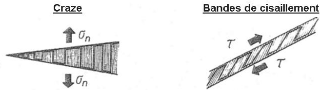
Figure I.6 : Schématisation des deux principaux modes de déformation plastique des polymères semi-cristallins. [K. Friedrich – 1983]
