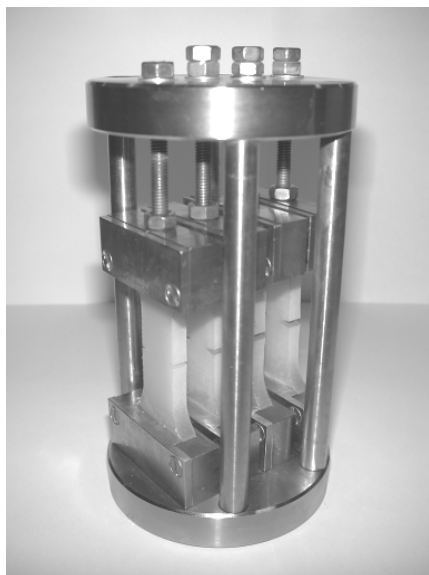
Figure B.1 : Bâti de vieillissement sous charge. Chaque éprouvette peut être sollicitée à un niveau de déformation différent. Exemple de vieillissement sur éprouvettes préfiaturées.
