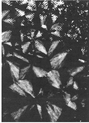
Figure II.6 : Observation des sphérolites du PA 11 en lumière polarisée avec polariseur et analyseur croisés : une faible épaisseur de polymère est recristallisée entre deux plaques de verre. Les annelures concentriques des sphérolites sont dues à la tension coopérative inter-lamellaire [Magill - 1969].
