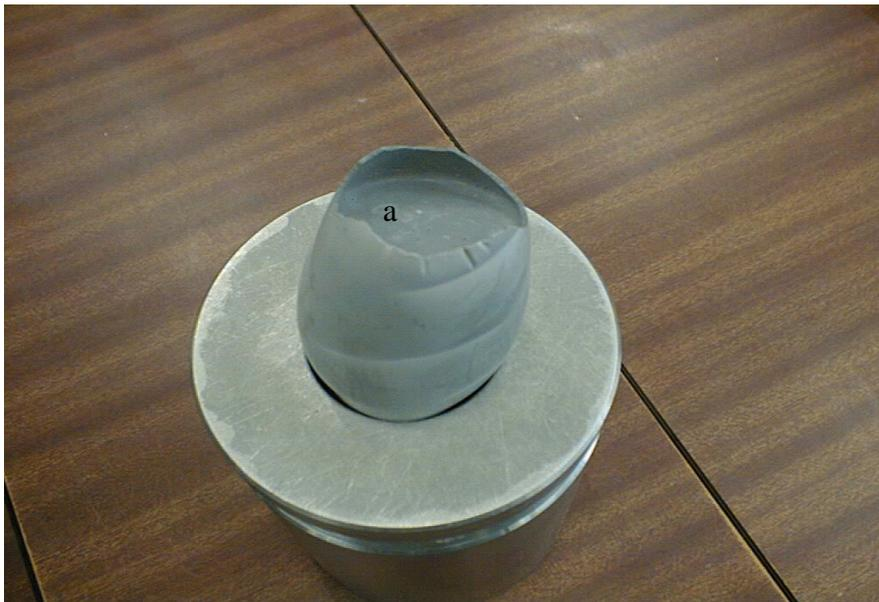
Photo III - 2 : Aspect de l'éprouvette montrant le volume d'air (a) en dessous du nœud
