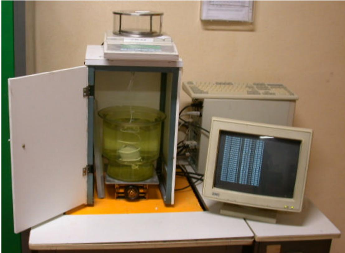
Photo III - 1 : Dispositif expérimental de mesure des variations volumiques
