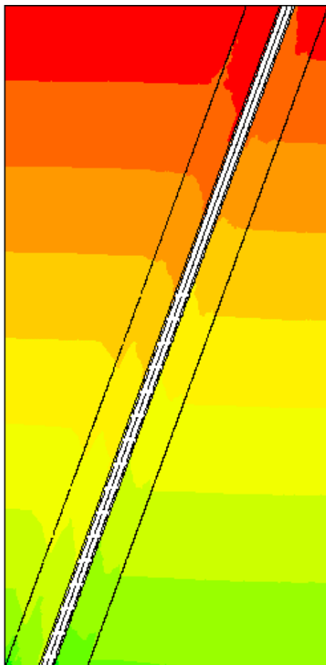
Figure 6.9 – Courbes d'isovaleurs de la contrainte verticale ( \sigma_{zz} ) développée dans le sol, visualisées dans une coupe verticale traversant le micropieu incliné (CESAR-LCPC).
