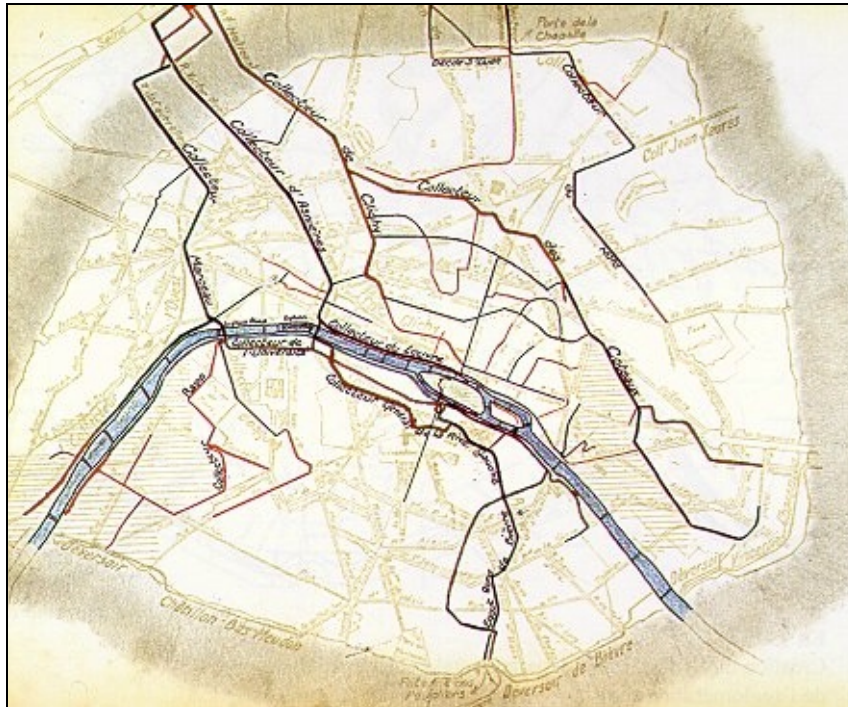
Figure VII-1 - Plan du réseau d'assainissement parisien, 1908
