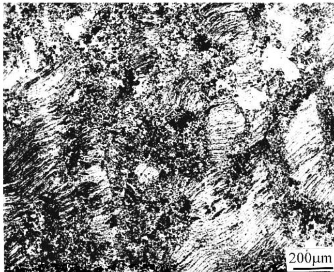
Figure 2.22 Microstructure après forgeage isotherme à 1150°C
