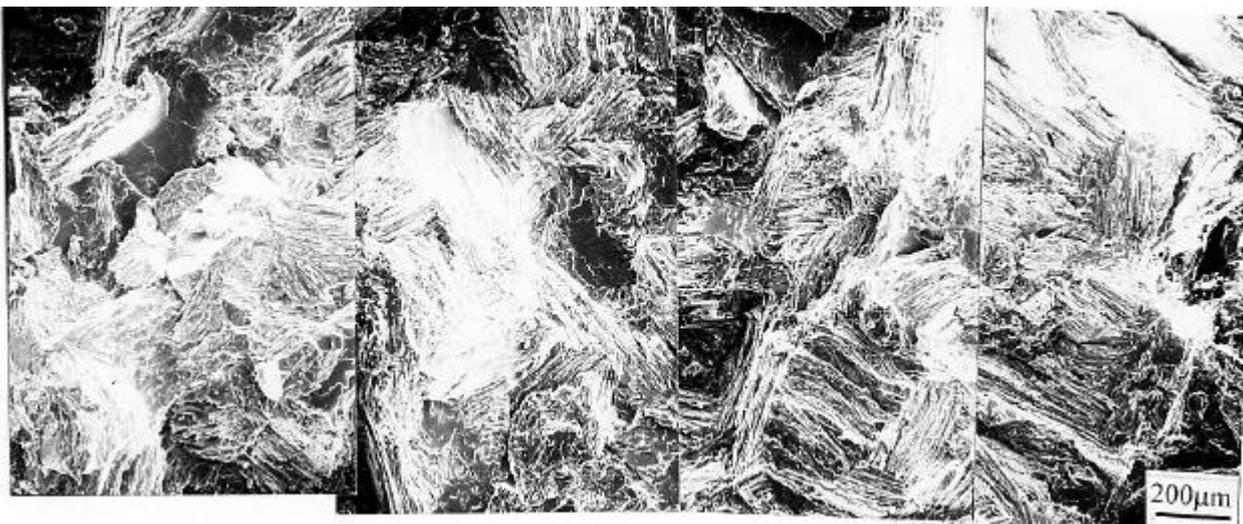
Figure 2.16 Morphologie complète de la surface de rupture
