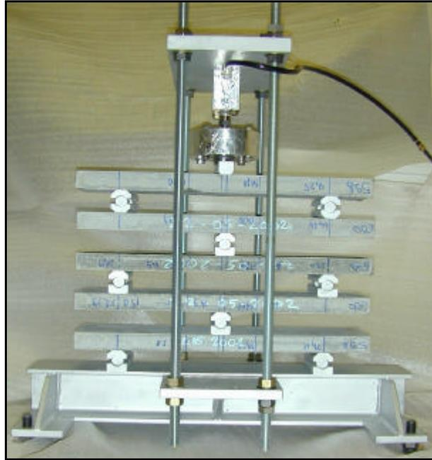
Figure 5.1 - Dispositif de fluage en flexion 3 points
