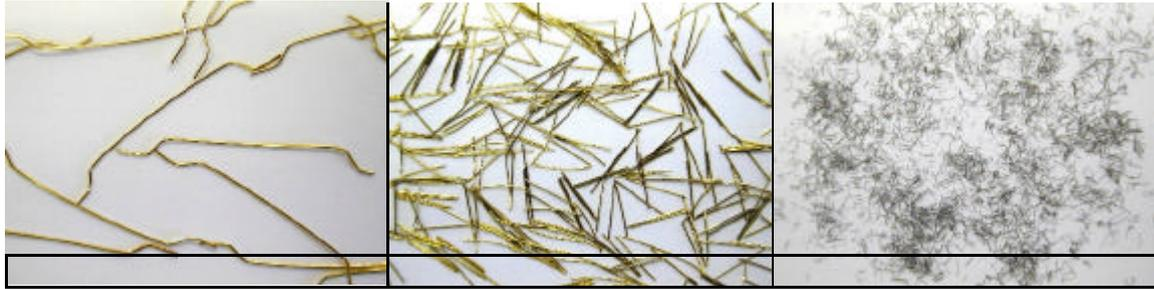
Figure 1.4 - Fibres métalliques utilisées : fibres longues à crochets (à gauche), fibres droites et courtes (au centre) et laine d'acier (à droite) à la même échelle
