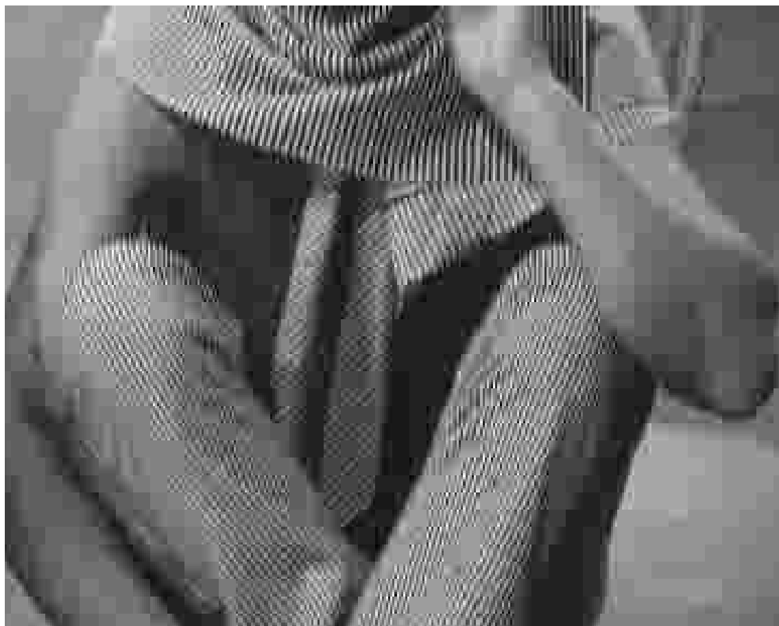
Figure 5.7: Barbara codée à 0.25bpp par le JPEG avec des quantificateurs optimisés PSNR=26.40dB
