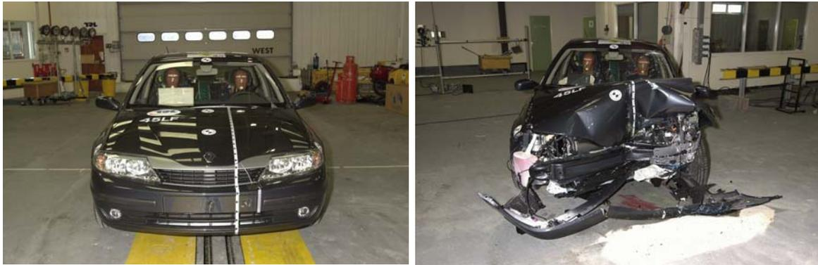
FIG. 16 – Vues de face d’une Laguna 2 avant (gauche) et après (droite) un choc frontal de type EuroNcap a 64 km/h et 40 % de recouvrement délimité par la ligne blanche sur la vue de gauche
