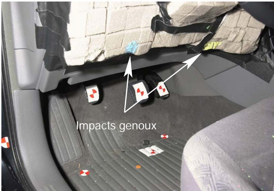
FIG. 21 – Bloc de mousses marqueurs après un choc frontal type EuroNCAP à 64 km/h et à 40 % de recouvrement. Les marques de couleurs indiquent les impacts des genoux du mannequin
