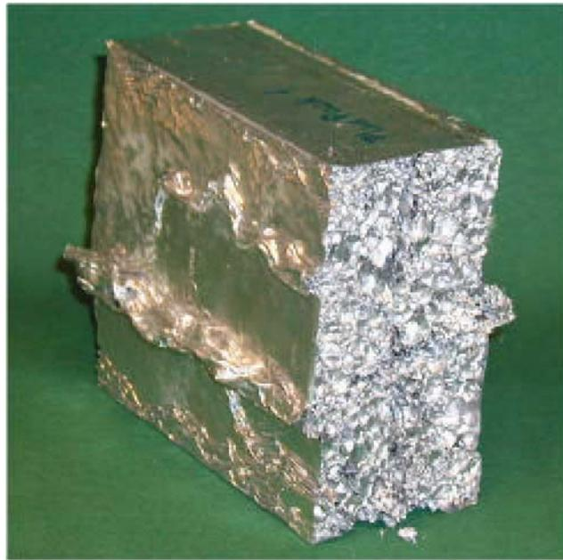
FIG. 2.6 – Visualisation des mouvements de blocs rigides lors de la compression d'une éprouvette à fort rapport d'élongement
