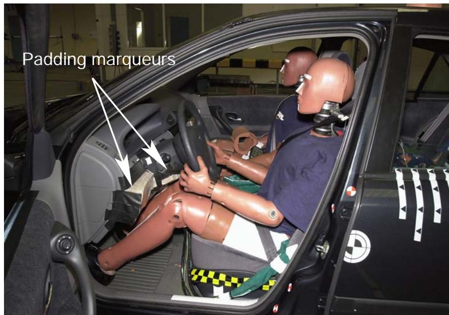
FIG. 20 – Préparation d'une planche de bord pour un choc frontal type EuroNCAP à 64 km/h et à 40 % de recouvrement. Les blocs de mousses indiquées sur la photos sont des marqueurs de choc afin de localiser la zone sous la planche sur laquelle les genoux du mannequins vont impacter
