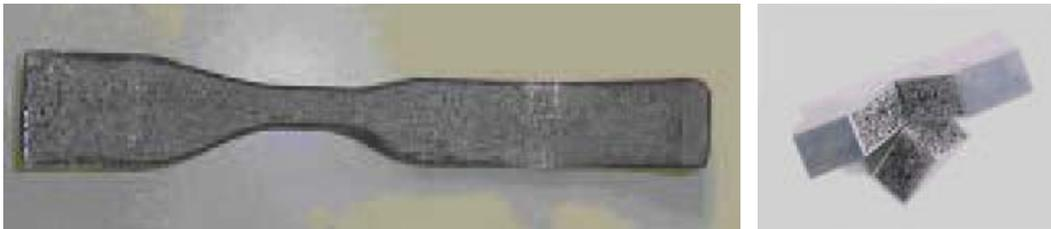
FIG. 17 – Exemple de remplissage de cœurs creux de formes complexes par de la mousse d’aluminium voie fonderie
