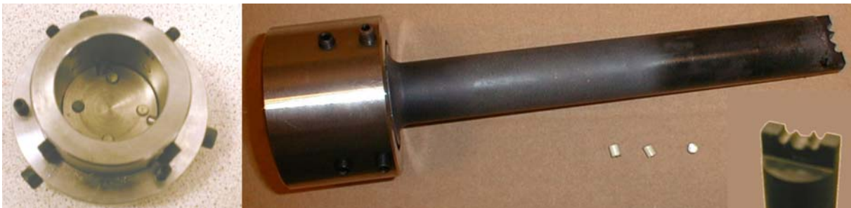
Figure 5.7 - Ligne inférieure en \text{SiC} , pions de zirconne et tripode.
