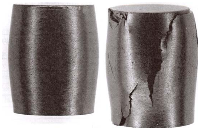
Figure 3.23 - Déformation en tonneau et fissuration de pastilles UO_2 sollicitées en fluage.
