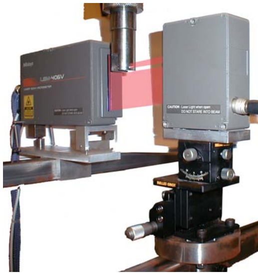
Figure 5.12 – Extensomètre laser (modèle LSM 3100 Mitutoyo).
