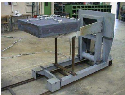
Figure 3.26 – Photographie de la brame sur l'enfourneuse manuelle.
