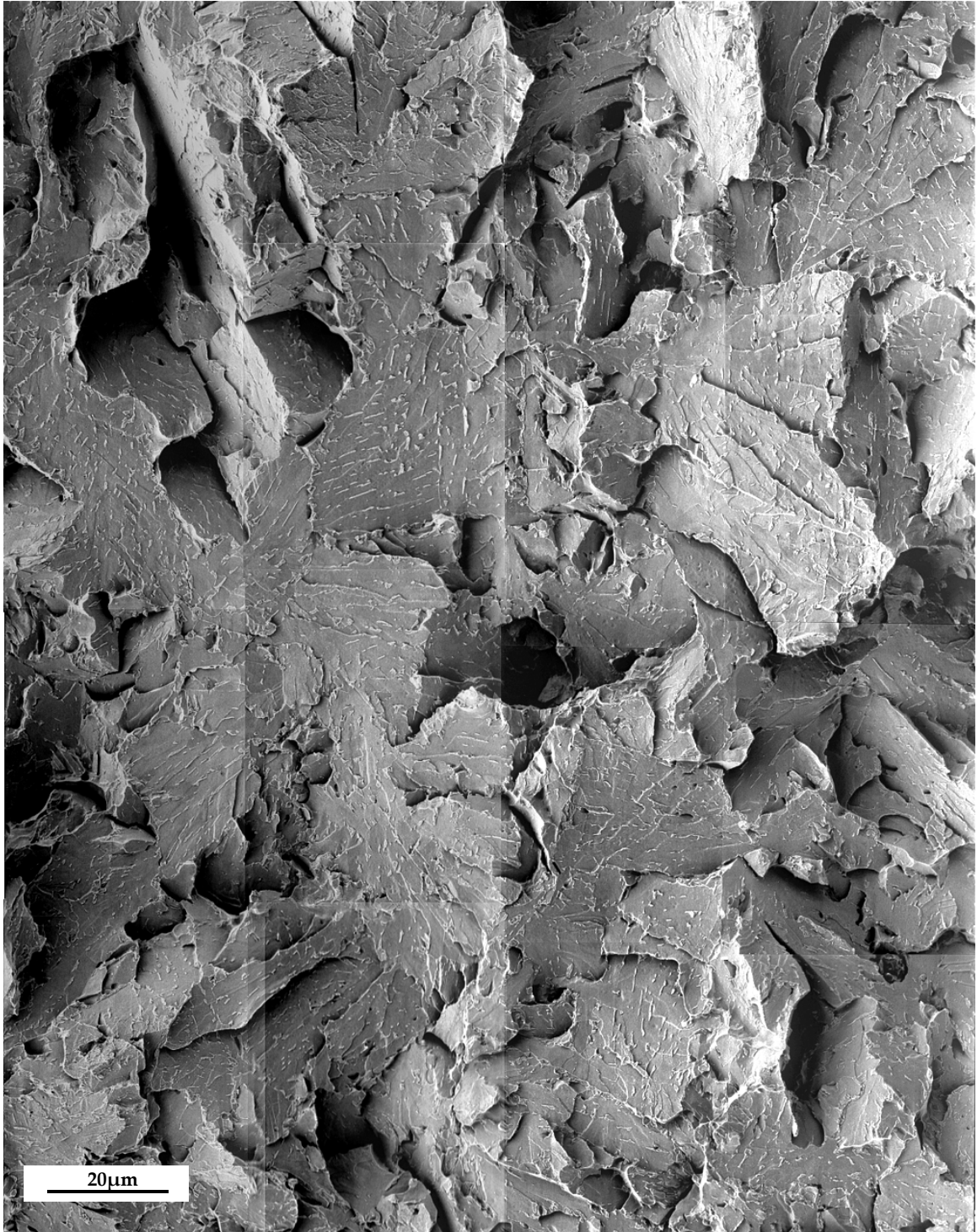
figure V. 7 : Faciès de rupture fragile par clivage d'une éprouvette AE4-50 de ICCGAZ-100s rompue à -160°C ( \epsilon=4\% ) après attaque métallographique Villela. L'attaque révèle la présence de composés M-A « en collier », parfois déchaussés, aux anciens joints de grains austénitiques.
