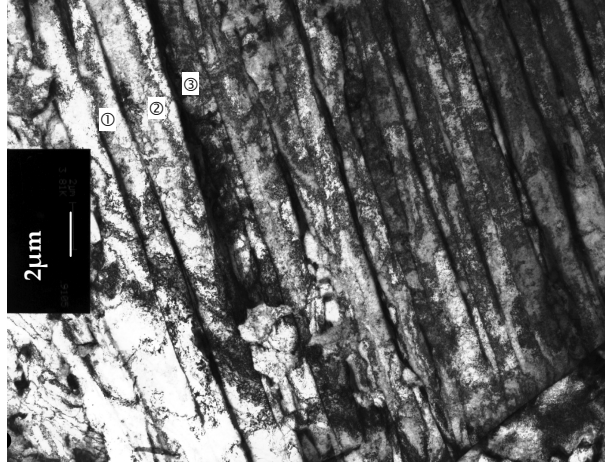
figure III. 11 : Micrographie au microscope électronique en transmission sur lame mince. Champ clair d'un paquet bainitique de la ZAC CGHAZ-100s. On constate la présence de fins carbures et de liserés d'austénite résiduelle (en noir) entre les lattes parallèles de ferrite bainitique, caractéristique de la bainite supérieure.
