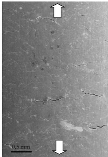
Figure III-48 : Fût d'éprouvette de fatigue isotherme  $T = 25^{\circ}\text{C}$ ,  $\varepsilon_m = \pm 1\%$ ,  $f = 0,1 \text{ Hz}$ ,
