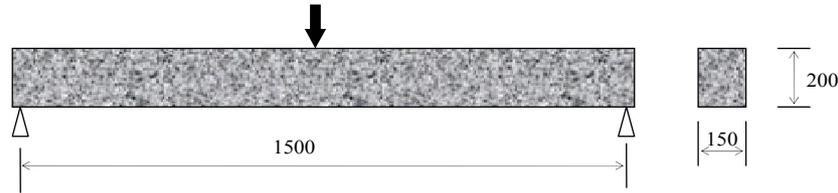
Figure IV-40. Poutre en flexion
