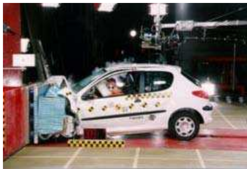
Figure 1 : peugeot 206 en choc frontal avec mannequins (source : EURO NCAP)
