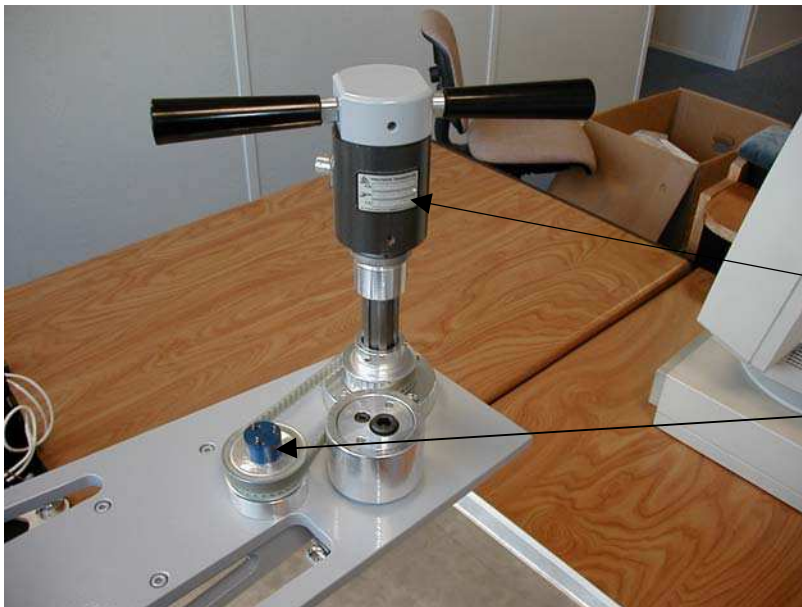
Figure 122 Poignée motrice avec capteur de couple. capteur de couple capteur de rotation
