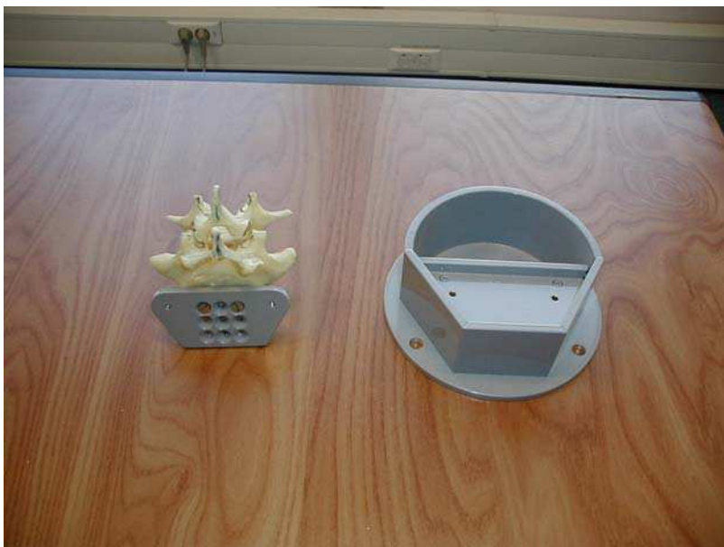
Figure 120 Bac recevant le spécimen
