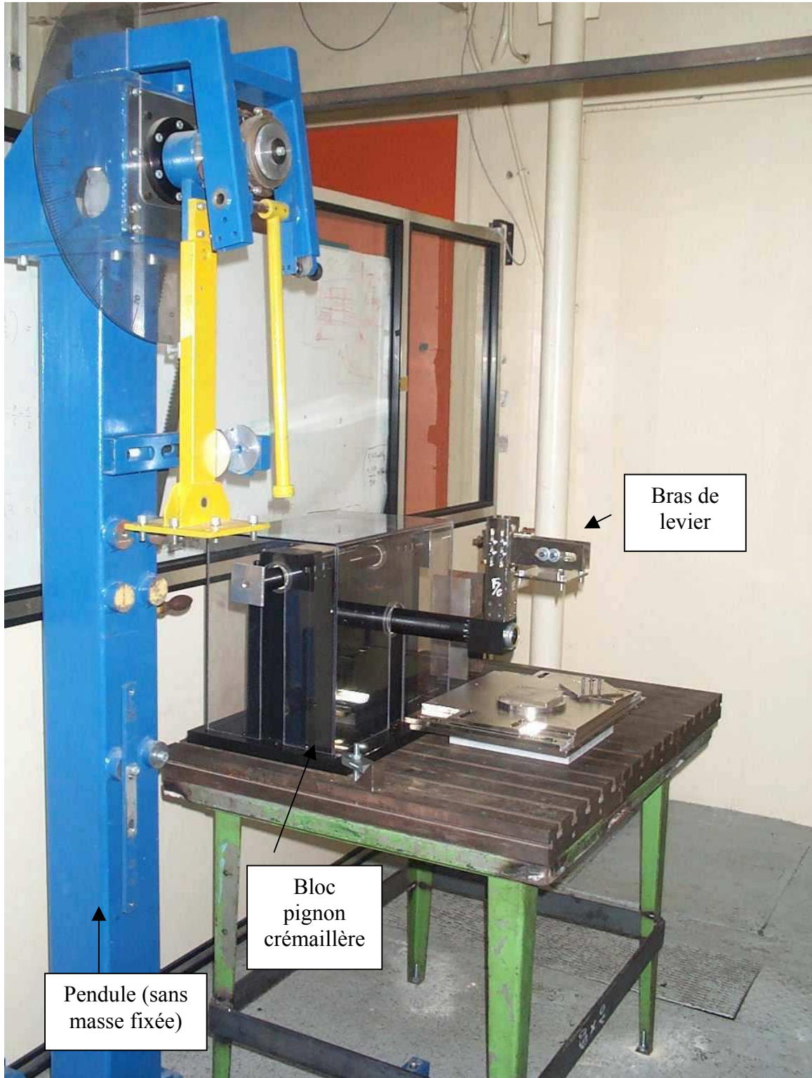
Figure 79 : photo du banc dynamique sans la masse du pendule
