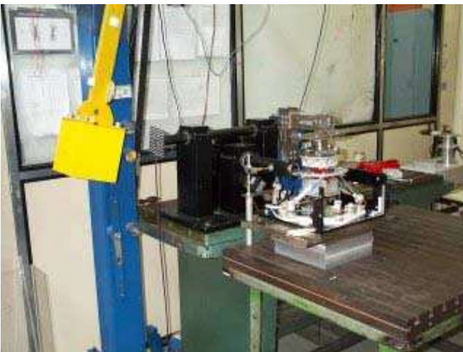
Figure 141 : Essai dynamique en inflexion
