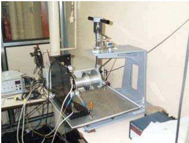
Figure 136 : Essai statique (mesure de référence) en inflexion
