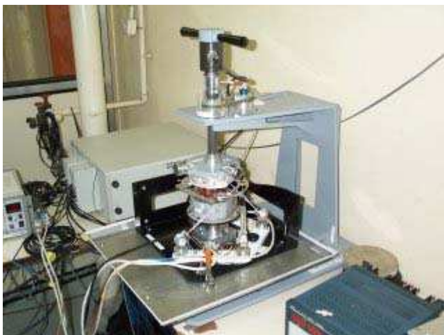
Figure 138 : Essai statique en torsion
