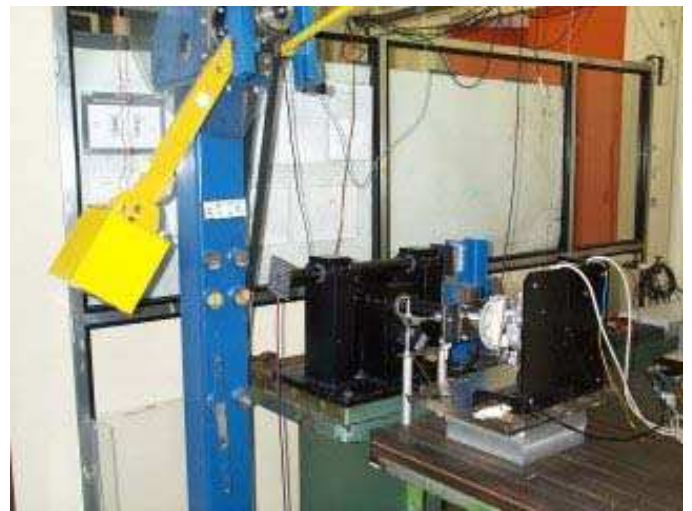
Figure 139 : Essai dynamique en torsion
