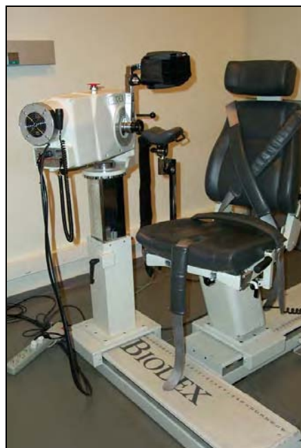
Fig. 1 : Le sujet est assis sur un siège amovible et est sanglé afin d'éviter tout mouvement non conforme au protocole expérimental. Le dynamomètre sur lequel le bras du sujet est attaché permet de contrôler le couple de force exercé.
