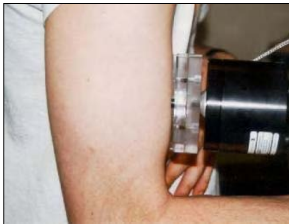
Fig. 8 : Montage expérimental in vivo . Le palpeur est appliqué directement à la surface du bras et la vitesse de l'onde de cisaillement est mesurée pour chaque position de la barre qui effectue une rotation de 0^\circ à 180^\circ par pas de 10^\circ .
