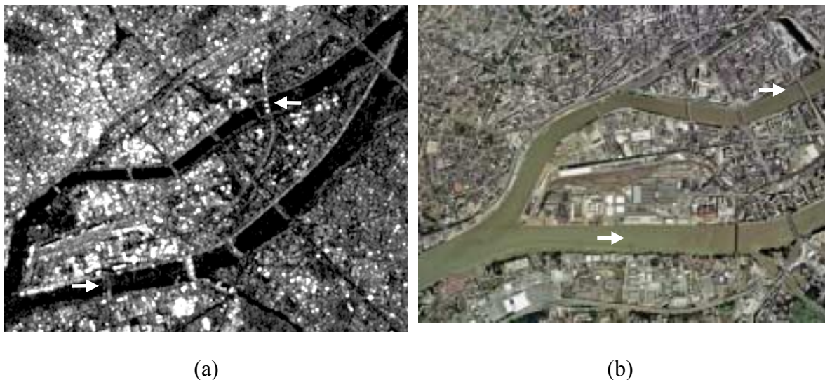
Figure 3.13. Les ponts de l'île de Nantes. (a) Détail d'une image RSO moyennée montrant deux ponts construits postérieurement aux prises de vues aériennes (flèches blanches). (b) Détail d'une vue aérienne montrant l'absence des ponts.
