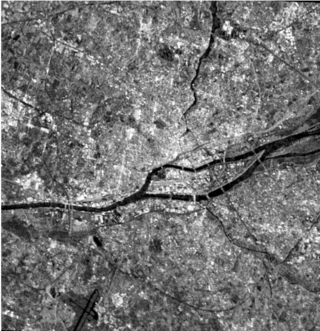
Figure 3.5. Image moyenne des six images PRI d'images rectifiées géométriquement en prenant comme référence une carte IGN 1 : 100 000.
