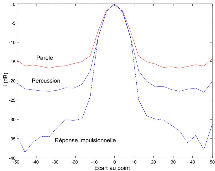
**Figure II-15 : qualité de focalisation obtenue avec des signaux complexes**
