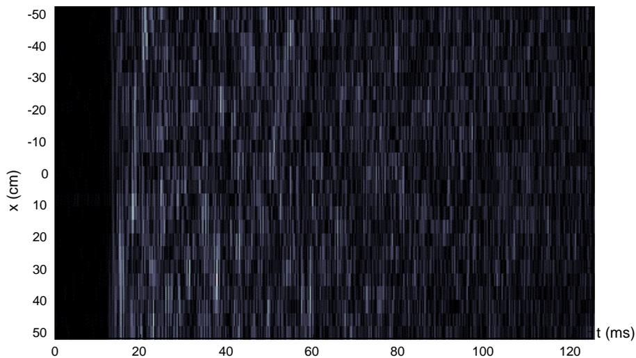
**Figure I-29 : B-Scan<sup>7</sup> mesuré sur l'axe x pour l'émission du haut-parleur numéro 8**
