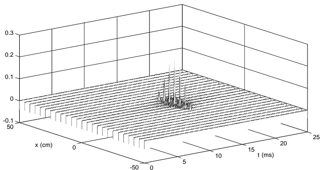
**Figure II-10 : objectif typique choisi pour obtenir une tache focale par filtrage inverse**
