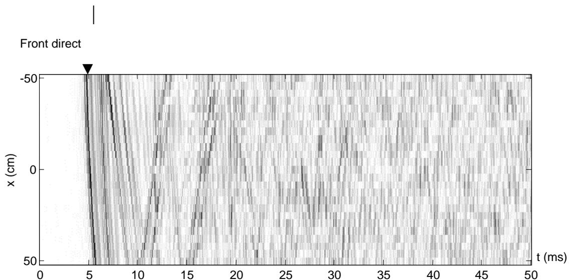
**Figure II-6 : Colonne de l'opérateur de propagation dans une pièce, pour les positions d'émetteurs et de récepteurs décrites. Il s'agit de la réponse de diffraction d'un haut-parleur, vue par les différents point de contrôle.**
