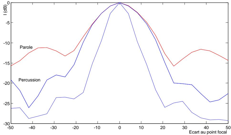
**Figure I-19 : Focalisation en fonction du contenu spectral**
