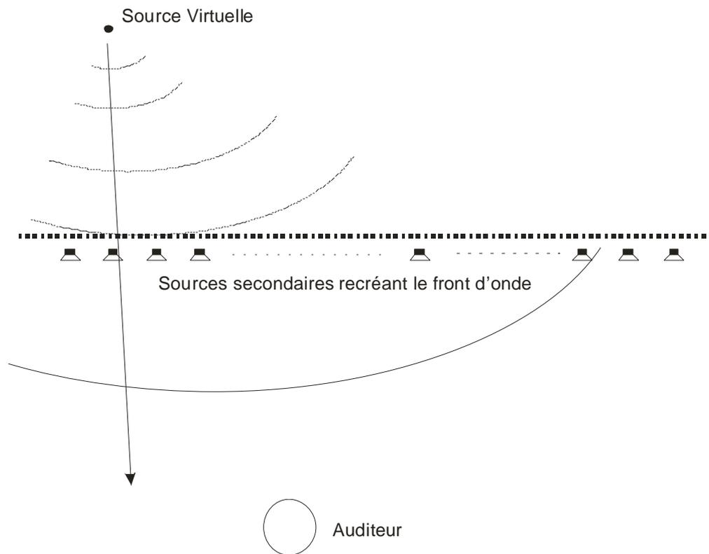
**Figure IV-2 : Principe de fonctionnement d'un système holophonique.**
