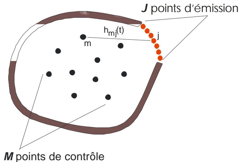
**Figure II-1 : Milieu de propagation et notations**
