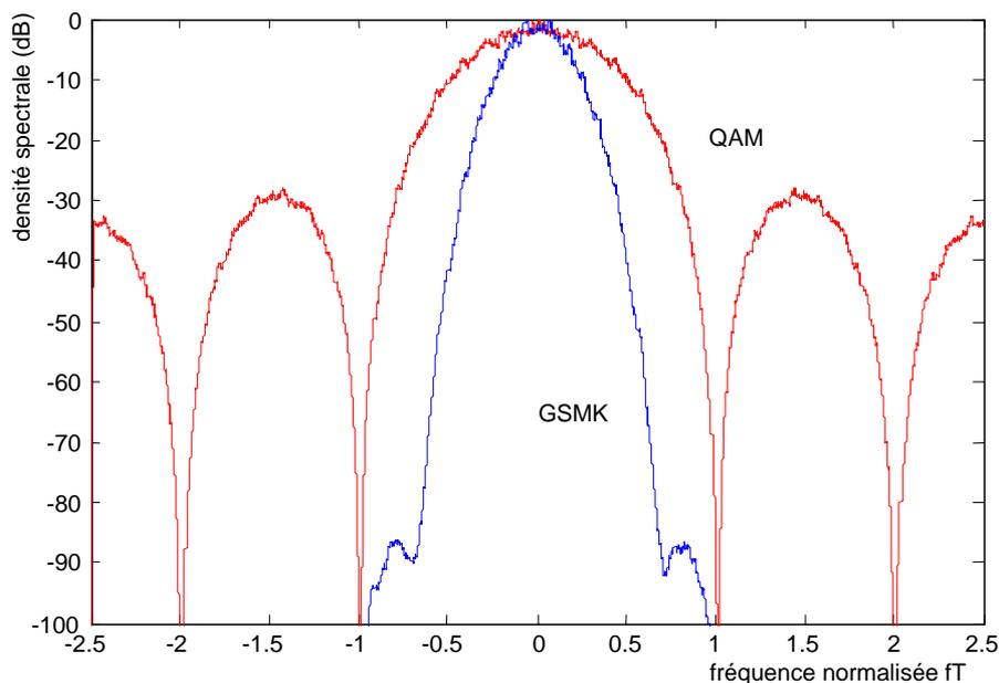
**Figure B-3 : Comparaison des spectres des signaux émis, pour une modulation BPSK et pour une modulation de type GSM européen (GMSK) ; pour un même taux de transfert.**
