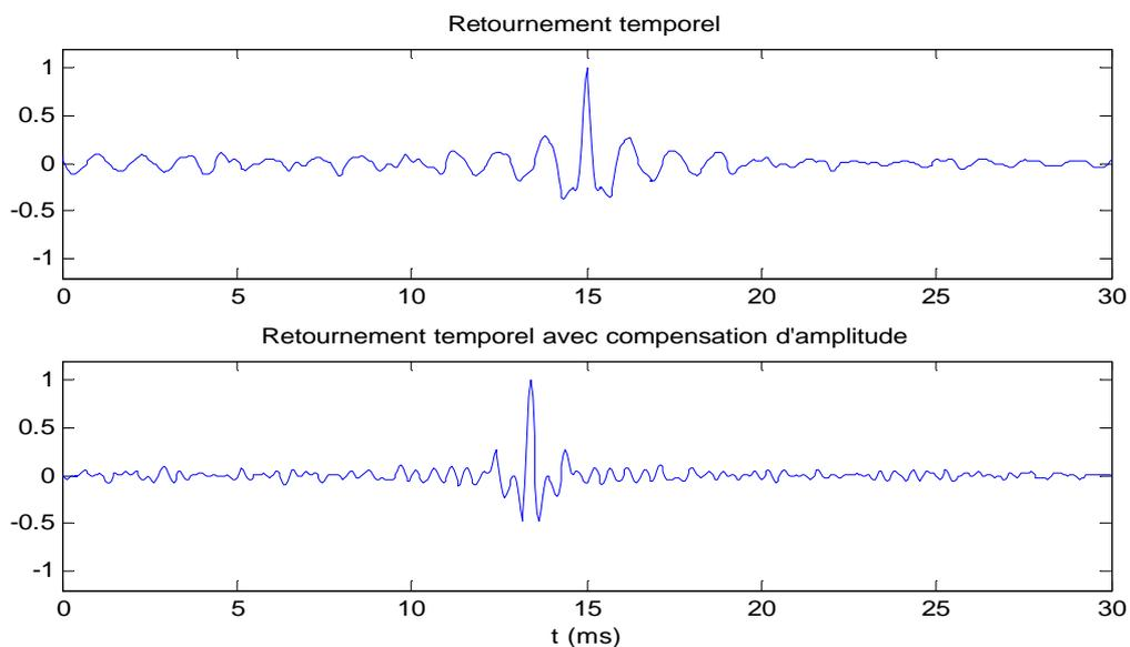
**Figure I-35 : impulsions recrées après retournement temporel, avec et sans compensation d'amplitude**
