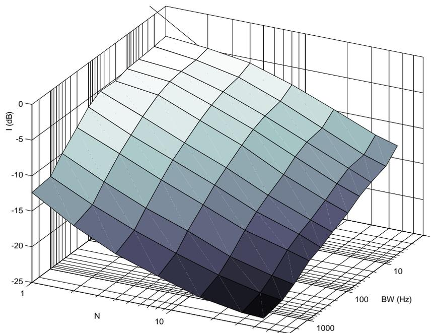
**Figure I-18 : Niveau des lobes secondaires en fonction de la bande de fréquences et du nombre de transducteurs utilisés, pour une focalisation par retournement temporel**
