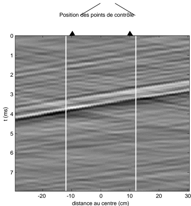
**Figure IV-6 Champ obtenu (B-Scan) autour des microphones**
