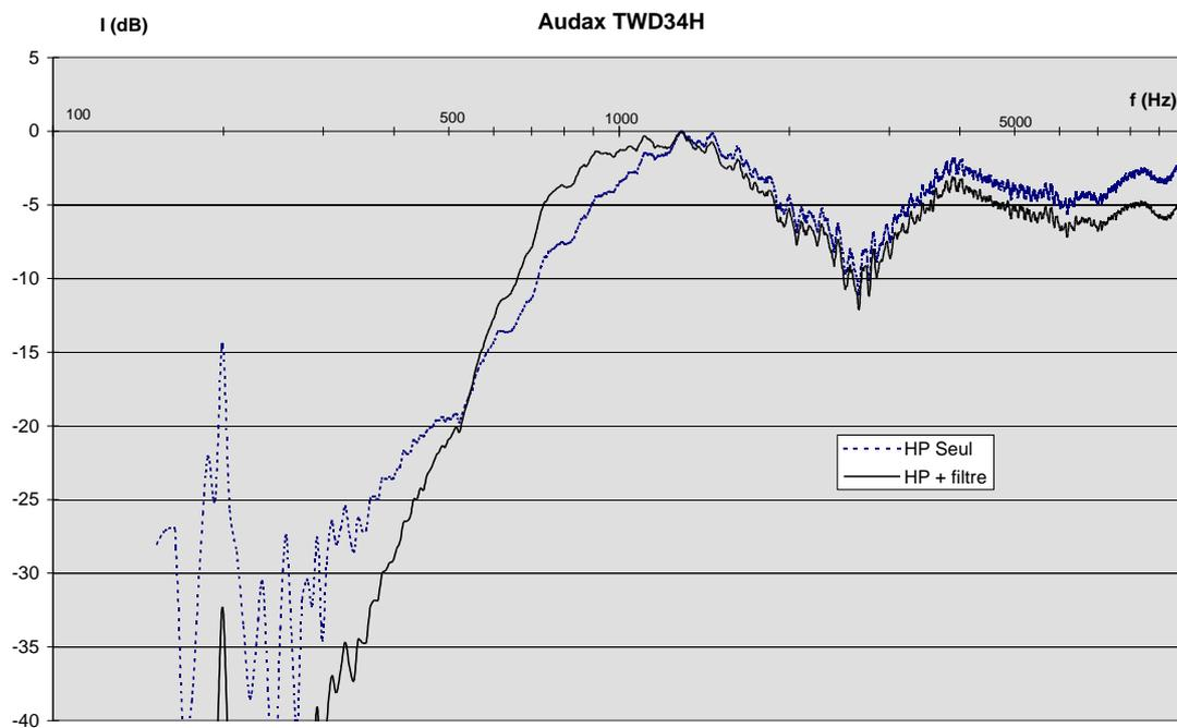
**Figure IV.E-3 : Fonction de transfert du Haut-parleur mesurée dans l'axe ; l'introduction du filtre permet d'élargir la bande passante vers les basses fréquences**
