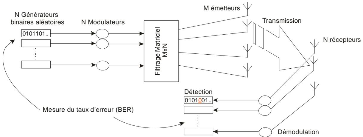
**Figure III-7 : Synoptique du système utilisé pour les mesures du taux d'erreur**
