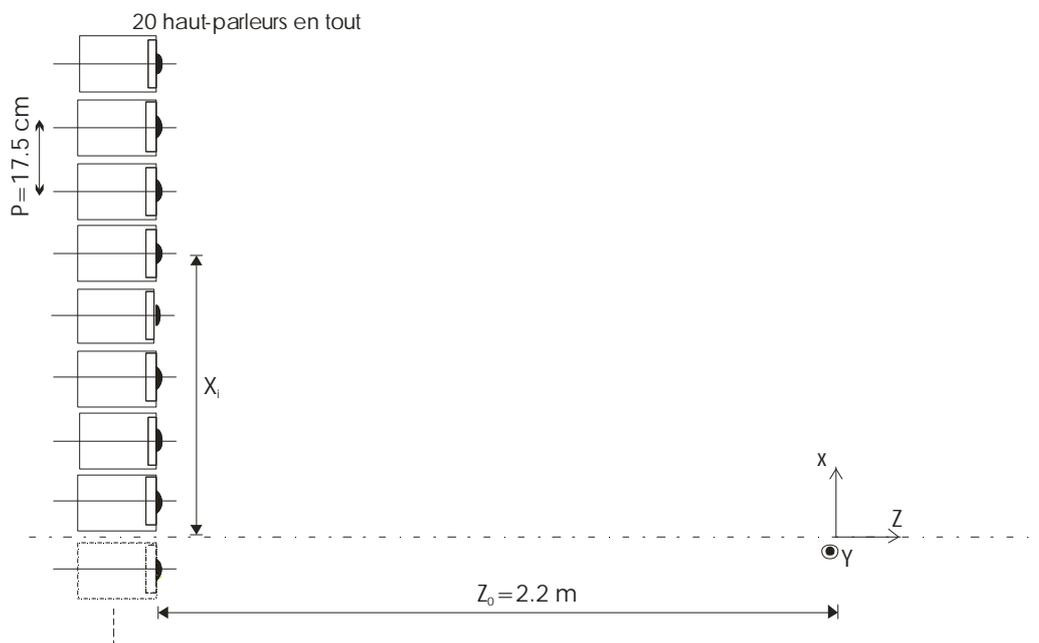
**Figure I-1 : configuration utilisée pour l'approche théorique en espace libre. (seule la partie  $x > 0$  est représentée, le modèle étudié est symétrique par rapport à l'axe z)**
