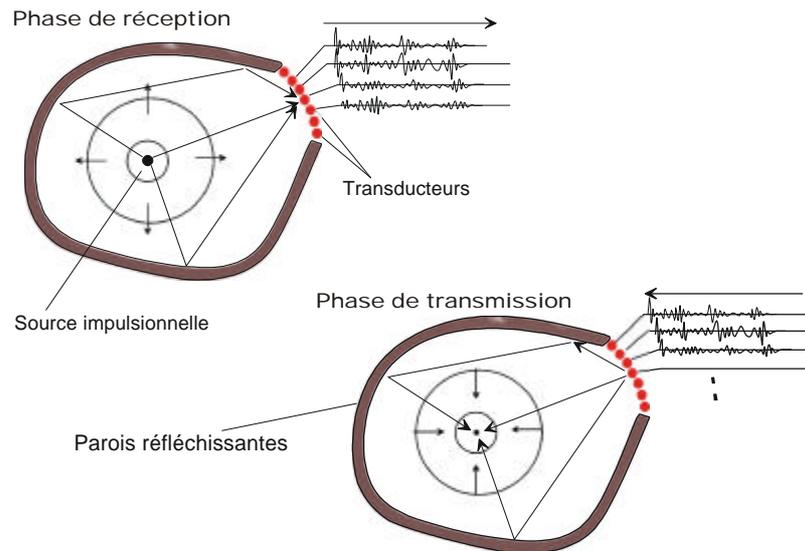
**Figure I-8 : Retournement temporel dans une cavité réfléchissante**
