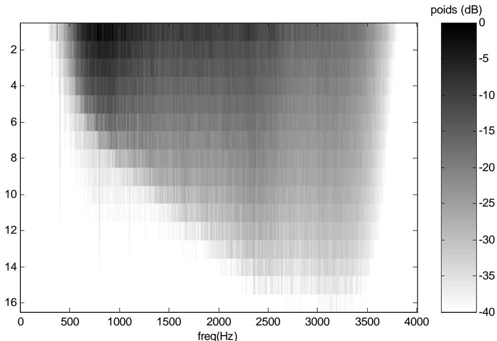
**Figure II-20 : Valeurs singulières obtenue pour l'opérateur de propagation mesuré au travers de la cloison.**
