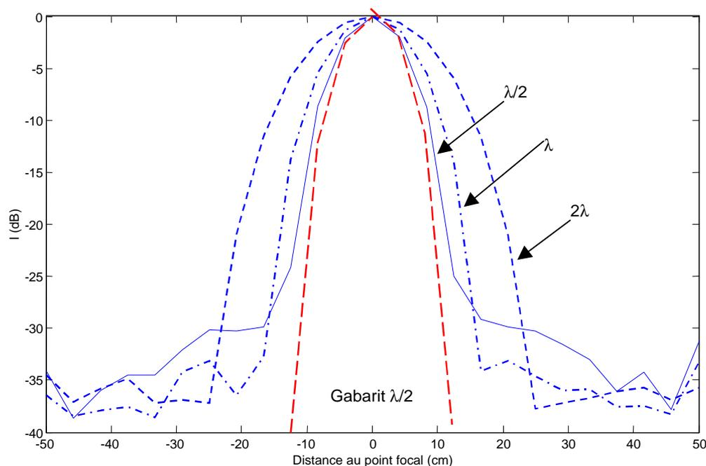
**Figure II-13 : Diagrammes de focalisation obtenus pour des gabarits de largeurs  $\lambda/2$ ,  $\lambda$ , et  $2\lambda$ . Seul le gabarit de largeur  $\lambda/2$  est représenté.  $\lambda$  correspond à la longueur d'onde pour la fréquence de résonance des haut-parleurs, soit 34 cm.**
