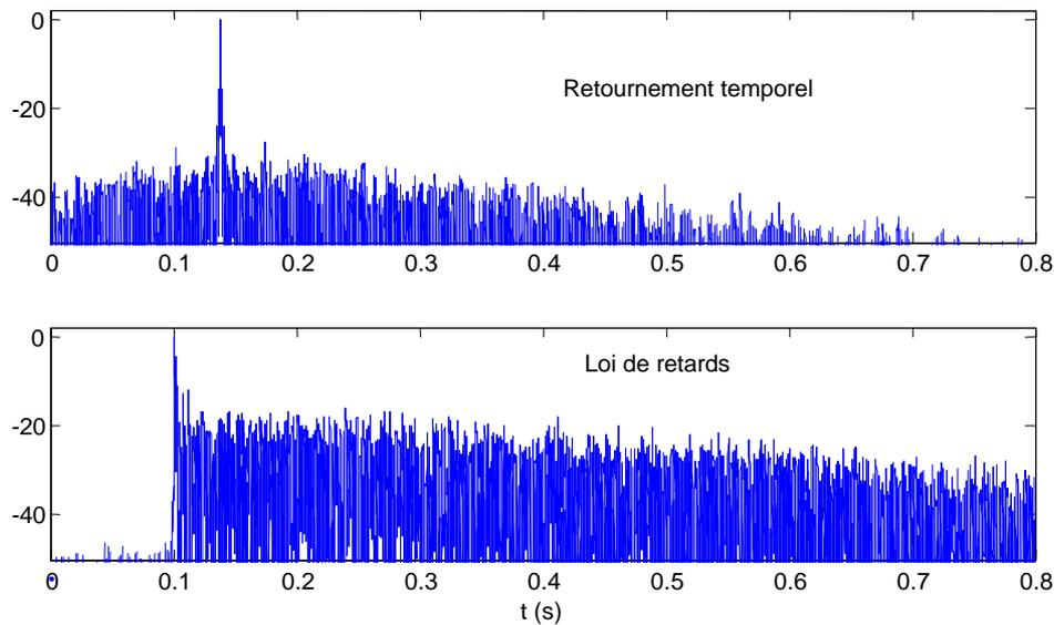
**Figure I-25 : Niveau des lobes secondaires temporels, représentation logarithmique**
