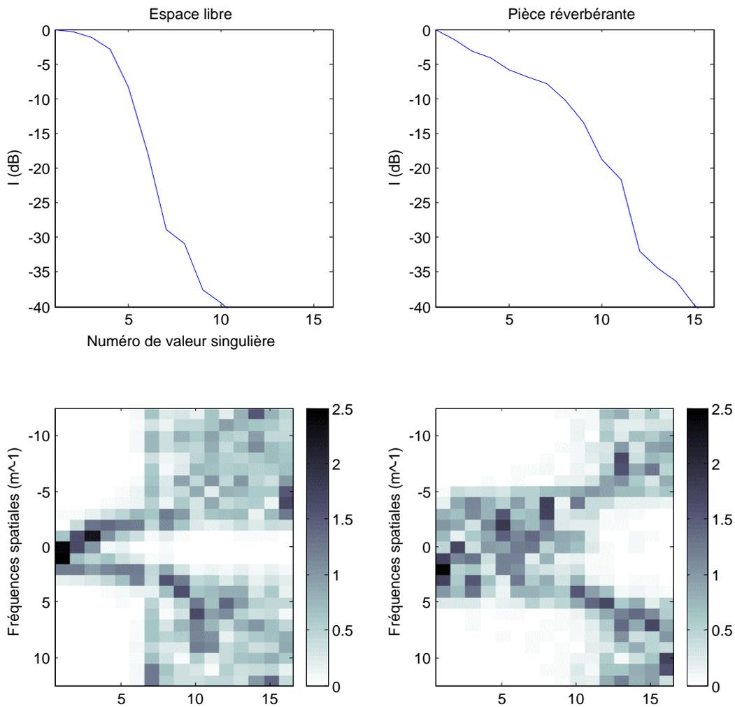
**Figure II-8 : Poids des valeurs singulières et amplitude de la transformée de Fourier spatiale des vecteurs propres correspondants, pour la fréquence  $f_0=1500$  Hz**
