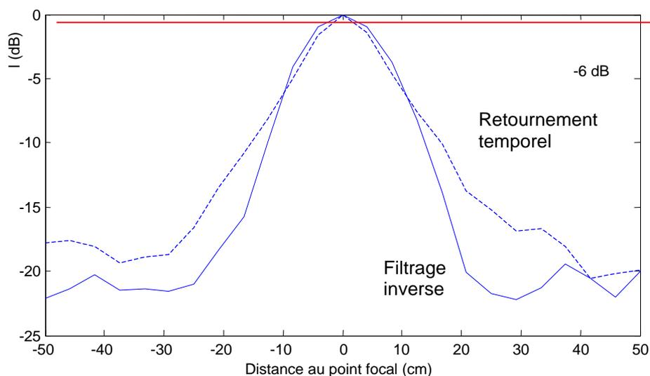
**Figure II-24 : Diagrammes de focalisation impulsionnelle**
