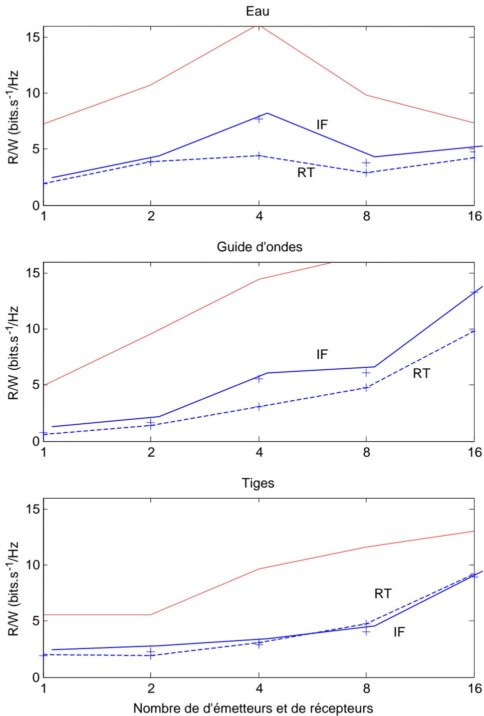
**Figure III-11 : Comparaison des débits effectifs obtenus par retournement temporel et par filtrage inverse**
