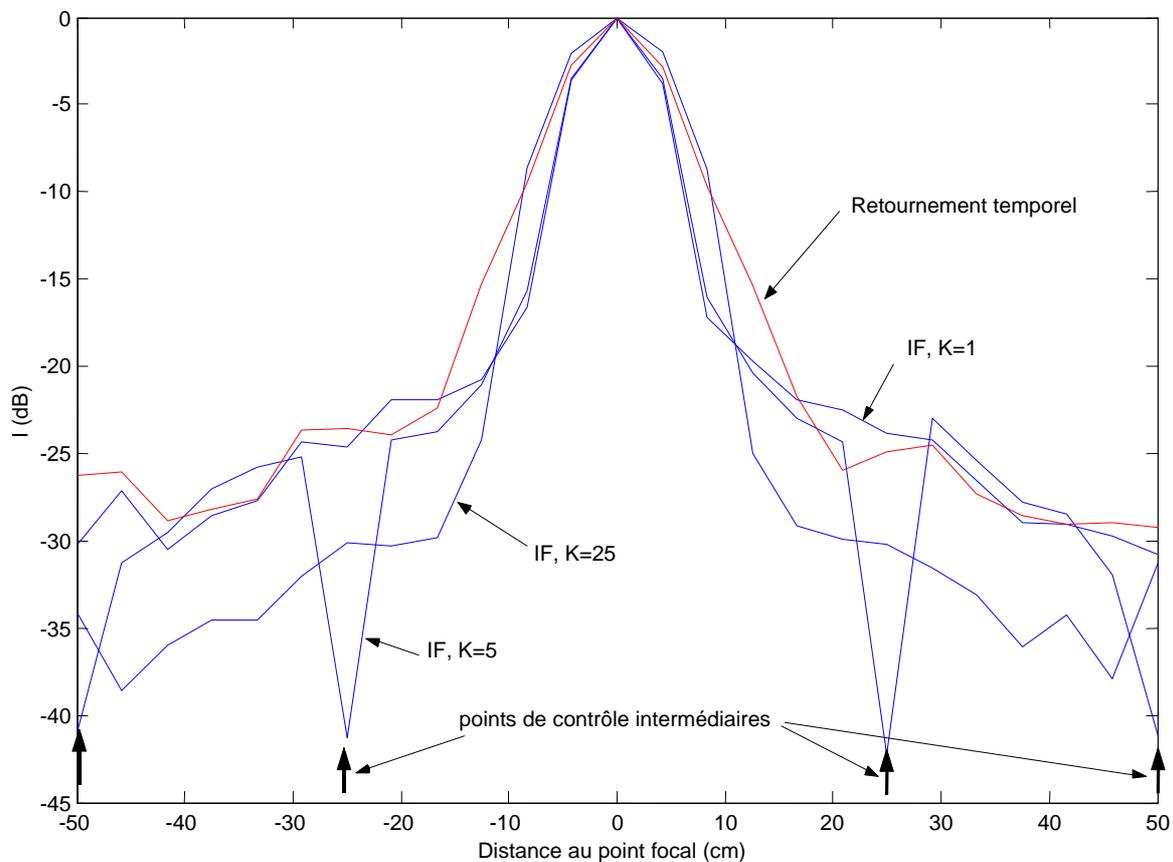
**Figure II-12 : Diagrammes de focalisation, obtenus par retournement temporel, et par filtrage inverse avec un nombre de points de contrôle variable**
