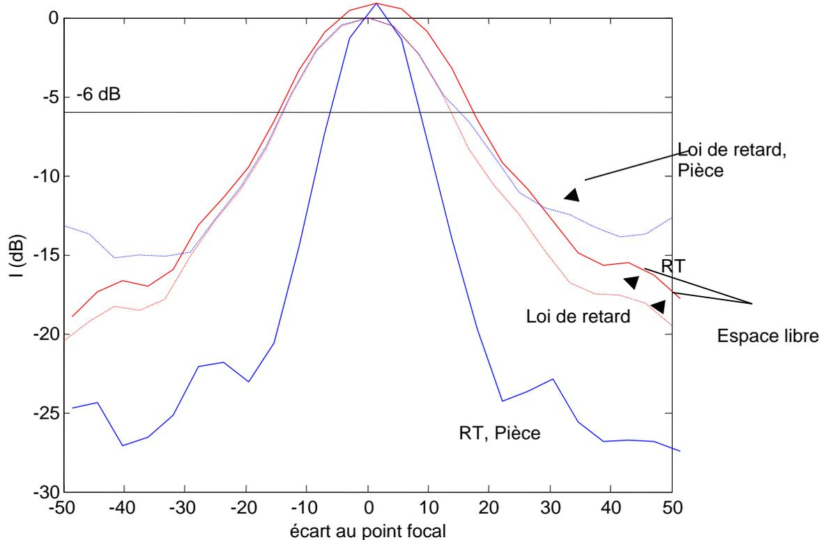
**Figure I-14 : Diagrammes de focalisation obtenus dans les conditions suivantes : Loi de retards en espace libre et dans la pièce vide (courbes en pointillés) Retournement temporel en espace libre (continu, rouge) et dans la pièce vide (continu, bleu)**
