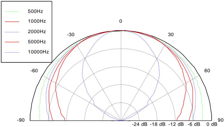
**Figure IV.E-4 : Diagrammes de directivité pour différentes fréquences.**
