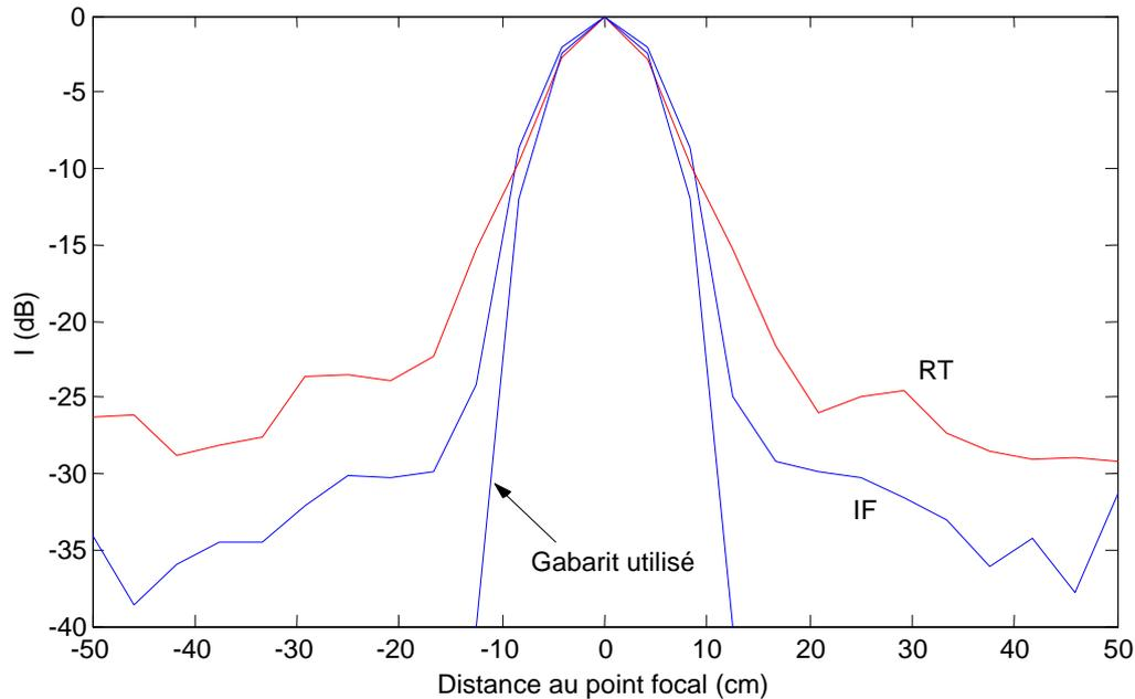
**Figure II-11 : Diagrammes de focalisation impulsionnelle<sup>13</sup>, dans le cas d'une focalisation par retournement temporel, et dans le cas d'une focalisation par filtre inverse. L'objectif est une tache focale de largeur  $l/2$**
