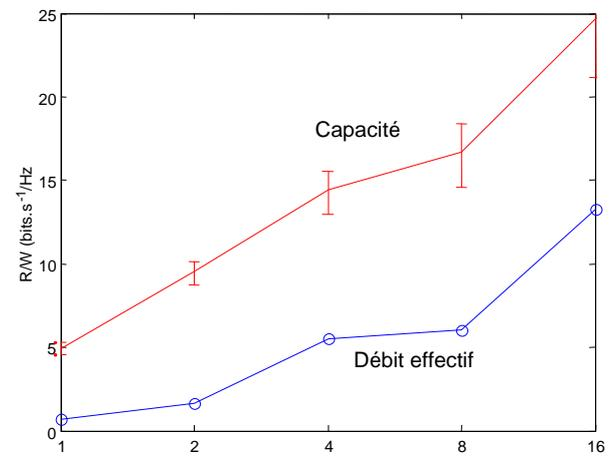
Figure III-9 : Capacité mesurée et débit effectif obtenu par filtrage inverse dans les différentes configurations (pour un BER de 10<sup>-5</sup>)
