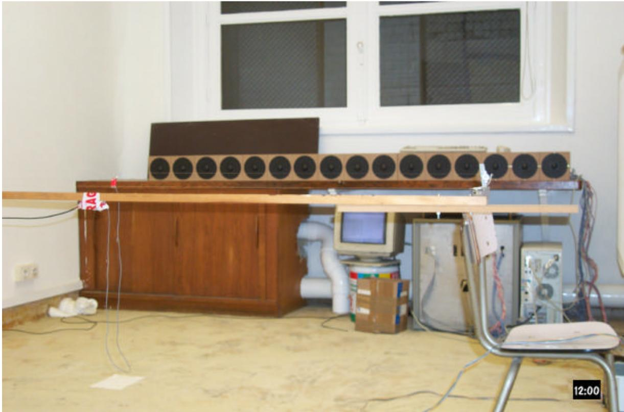
**Figure II-5 : Pièce réverbérante, avec le banc de mesure en position centrale**
