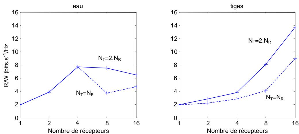
**Figure III-10 : Apport de la diversité spatiale : comparaison des cas où le nombre d'émetteurs est le même que le nombre de récepteurs, et des cas où le nombre d'émetteurs est le double du nombre de récepteurs.**
