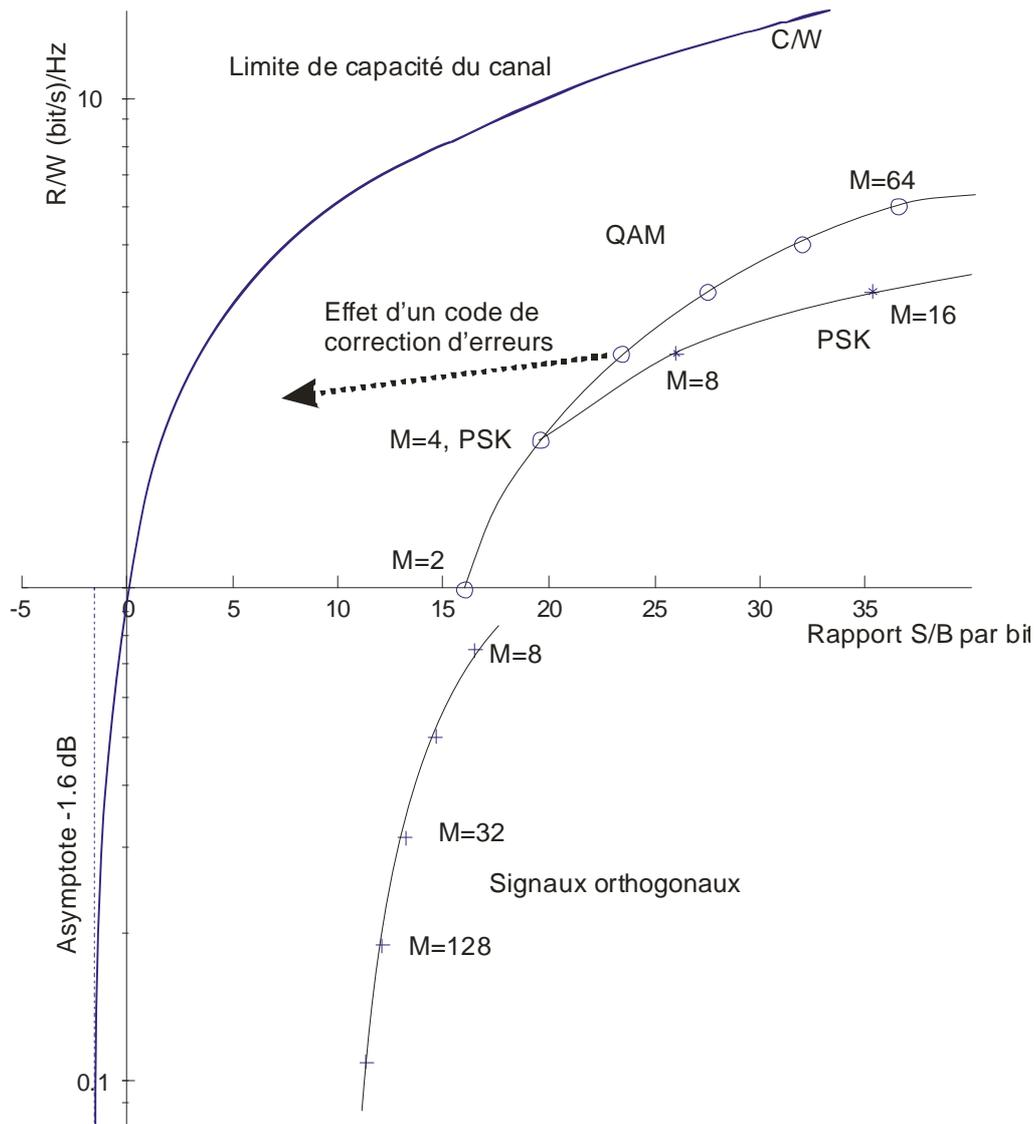
**Figure III-2 : Débits et sensibilité au bruit des différentes techniques de modulation, pour un taux d'erreur de  $10^{-5}$ .  $M$  est le nombre de symboles différents intervenant dans la modulation.**
