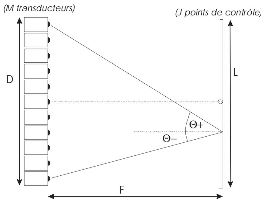
Figure II-2 : Géométrie basique du système émission-réception
