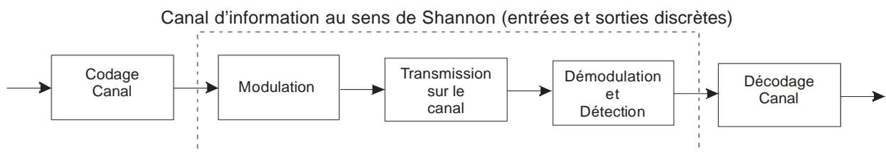
**Figure III-1 : Canal composite.**
