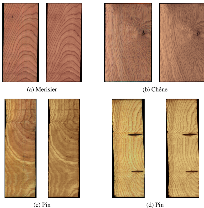
FIG. 8.2. – Quatre reconstructions de la couleur des planches de bois à partir de leur luminance. L'image couleur de départ est montrée à gauche, et l'image couleur reconstruite à partir de la luminance avec les paramètres calculés de la base correspondante est montrée à droite.
