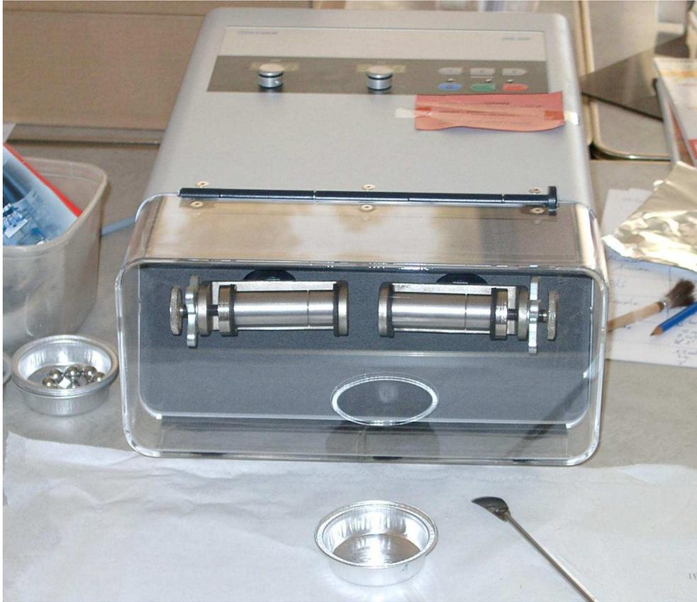
Figure 24 : Vibroboyeur oscillant utilisé pour broyer le substrat résiduel récolté dans les sachets mobiles
