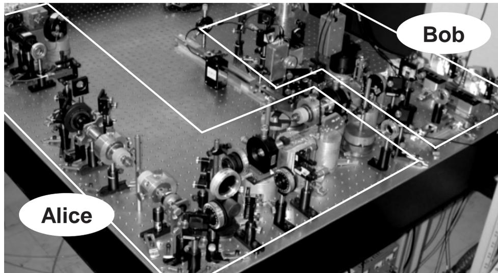
Figure 5.2: Photographie du montage expérimental. Alice et Bob ne sont distants que de 7cm, mais des éloignements arbitraires peuvent être simulés en induisant des pertes grâce à la lame BS de transmission variable.
