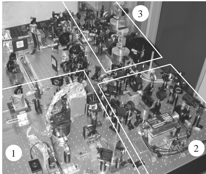
Figure 9.2: Photographie du montage complet montrant les éléments de détection homodyne (1), de conditionnement (2) et de source du vide comprimé (3).
