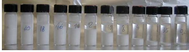
FIG. 1.25: Effet de la fraction volumique sur la hauteur de sédimentation de particules de silice (2,5 \mu\text{m} de diamètre) en présence de calcium (de droite à gauche 0.3, 0.75, 2.9, 5.9, 8.9, 15, 18, 21, 24, 27, 30, 33%), pH 10 + [\text{Ca}^{2+}] = 0.1 \text{ mol/l} .
