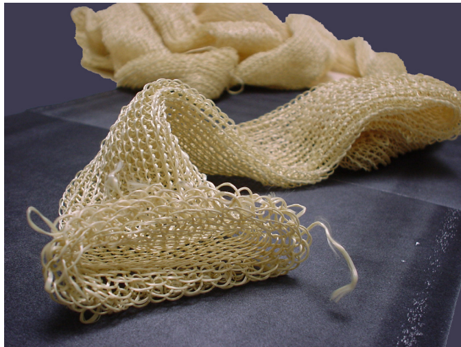
Figure 1-6 : Renfort tricoté issu d'un procédé de tricotage circulaire
