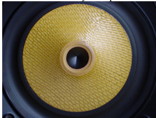
Figure 1-1 : Haut-parleur d'enceinte hi-fi en tissu d'aramide formé
