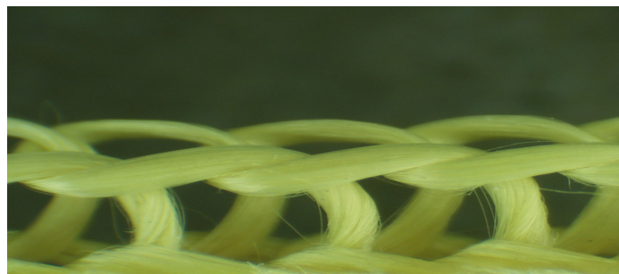
Figure 1-10 : Vue dans l'épaisseur du tricot étudié
