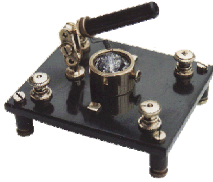
FIG. 3.5 – Photo [128]: Un poste à galène. La pointe à ressort (cat whiskers) vient en contact avec le morceau de galène fixé sur un support en laiton. Il faut rechercher par tâtonnement le point sensible de la pierre qui donne la meilleure audition. D'autres minéraux peuvent être employés comme détecteur : chalcopyrite, carborundum, silicium . . .
