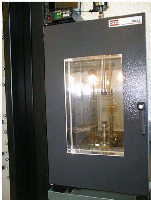
Figure II - 12 : Dispositif expérimental des essais de traction et de fluage des mousses de nickel de 100 à 200°C
