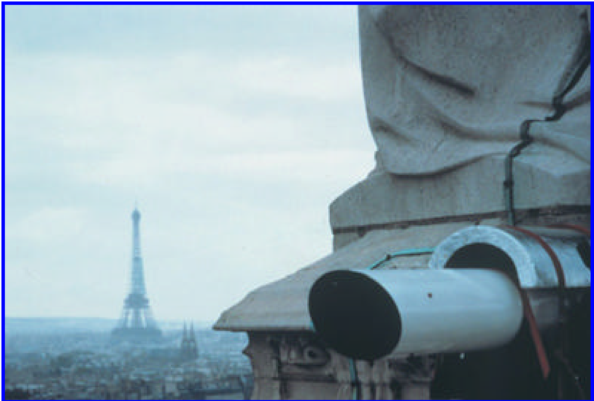
CNRS Photothèque - GOUTAIL Florence - Projecteur du SANOA, appareil de mesures de pollution à Paris.
