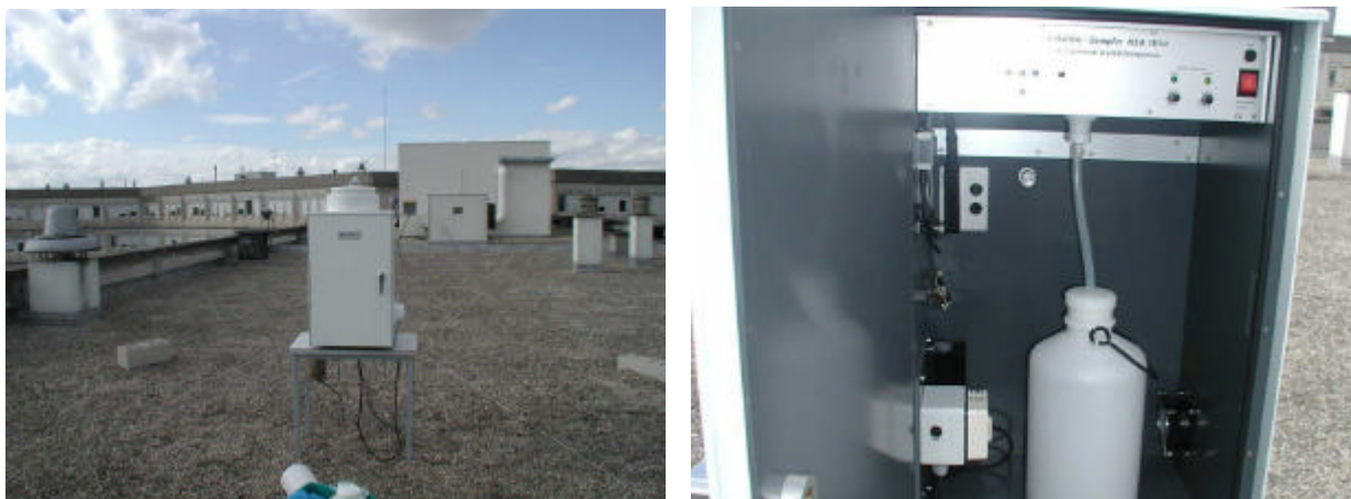
Figure 12. Collecteur de retombées atmosphériques humides (RH) à Créteil (Eigenbrodt NSA 181/E).
